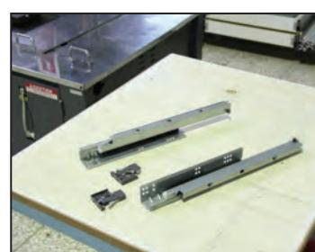
ریل توسط ۴ عدد پیچ ۱۶ میلی‌متری به بدنه فایل‌ها وصل می‌شوند. برای اندازه‌گیری کشوها یکی که از ریل زیر(ریل باتم) ساخته شده است معمولاً دو روش وجود دارد (بادخور بغل کشو تا بدنه مجموعاً ۱۰ میلی‌متر است).
