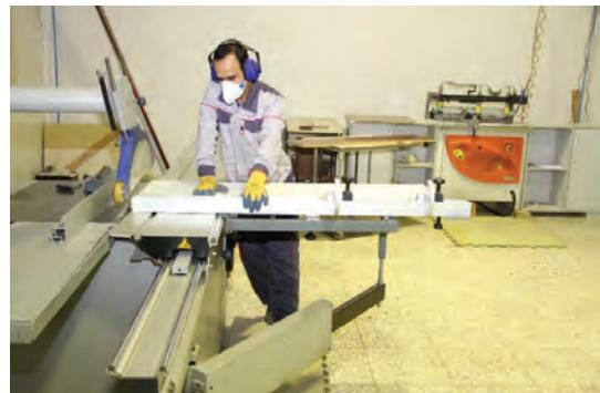
شکل ۷۶-برش توسط دستگاه پانل بر
