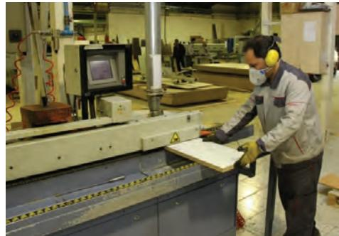
شکل ۷۹- نوار کردن قطعه کار
