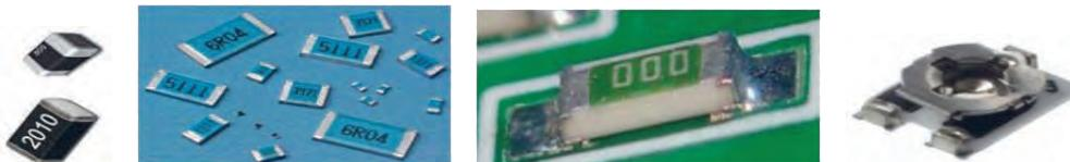
چند نمونه مقاومت نصب سطحی
