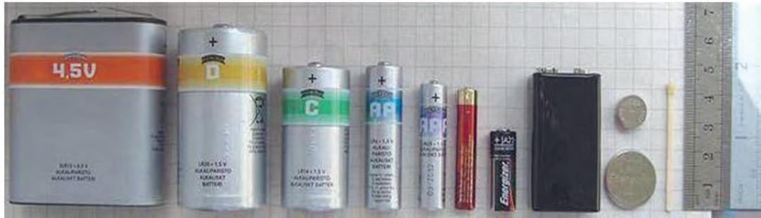
به طور کلی باتری‌ها به دو دسته قابل شارژ و غیر قابل شارژ تقسیم‌بندی می‌شوند. یکی از مهم‌ترین مشخصه‌های باتری‌ها به غیر از ولتاژ میزان جریان‌دهی آن است. که معمولاً بر روی بدنه آن بر حسب میلی‌آمپرساعت(mah) نوشته می‌شود. به عنوان مثال اگر بر روی بدنه یک باتری  $1200\text{ mAh}$  نوشته شده باشد این باتری قابلیت جریان‌دهی به یک مصرف‌کننده به میزان  $1200\text{ mA}$  در مدت یک ساعت را دارد.
