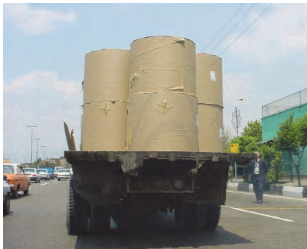
شکل ۳۷- نمونه‌ای از حمل نادرست رول‌های کاغذ
