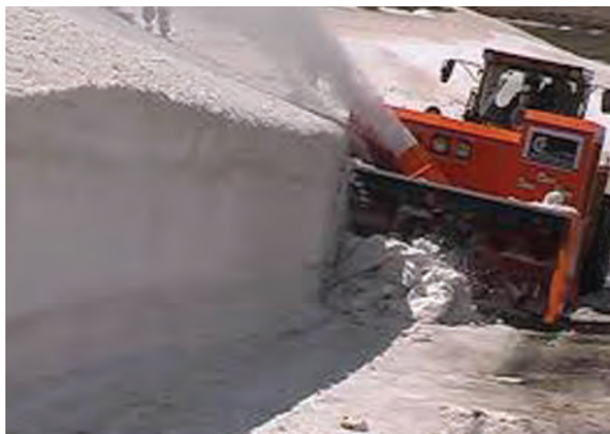
شکل ۹- یک دستگاه برف‌خور در حال پرتاب کردن برف به سمت بیرون راه
