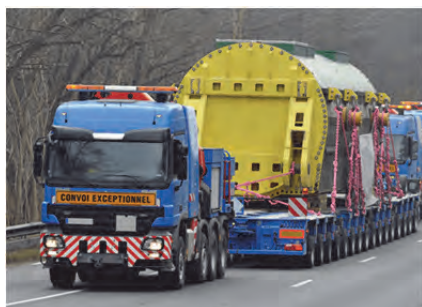
شکل ۱۰- نمونه‌ای از کشنده و یدک (بوژی)
