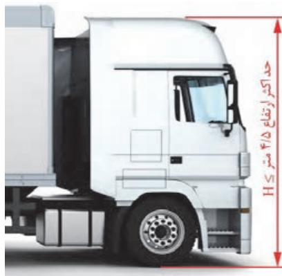
شکل ۴- حداکثر ارتفاع تعیین شده برای وسایل نقلیه
