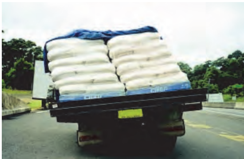
شکل ۳۲- عدم تعادل وسیله‌نقلیه به دلیل بارگیری نامناسب
