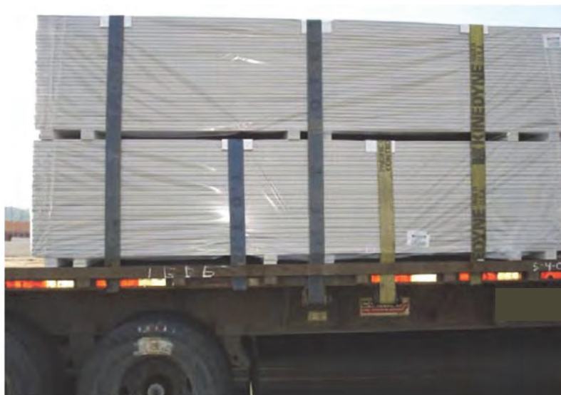
شکل ۴۹- نحوه چیدن ردیف‌های باندل روی هم
