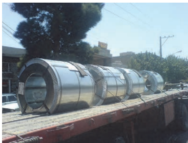
شکل ۴۲- نمونه‌ای از استقرار رول فلزی به صورت طولی با کمک جارولی
