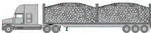
شکل ۴۷- نحوهٔ صحیح مهار عرضی چوب‌ها
