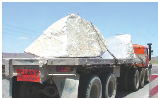
شکل ۱۷- نمونه‌ای از مهار نادرست سنگ‌ها
