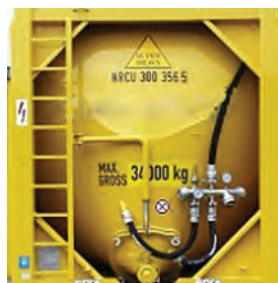
شکل ۲۹- شیرهای اهرمی و مدخل خروجی کانتینر
