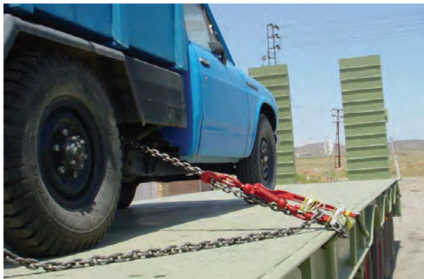
شکل ۲۲- نمونه‌ای از مهار نادرست یک اتومبیل
