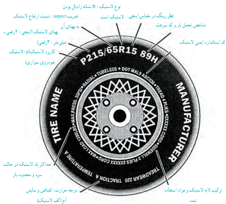
شکل ۵- سیستم شناسایی تایر
