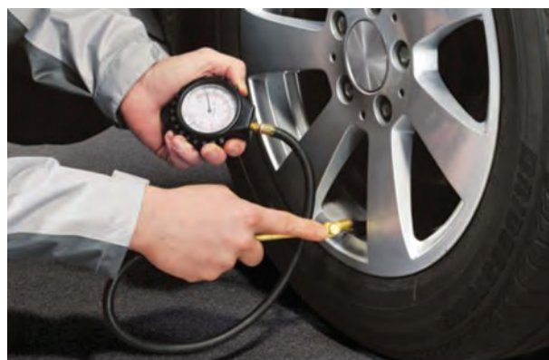
شکل ۱۰- اندازه‌گیری و تنظیم فشار باد تایر
