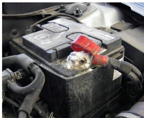
شکل ۴۱- سولفاته کردن قطب باتری
