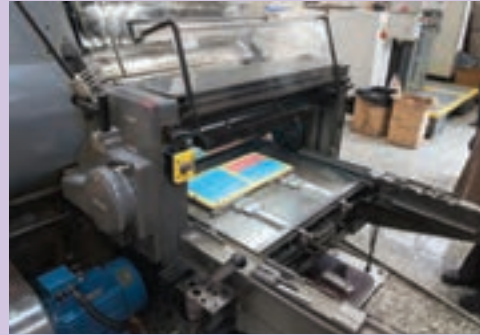
تصویر ۱۰ نصب قالب روی ماشین لترپرس
