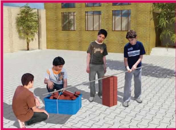
در آزمایش بالا میله‌ای که استفاده کردید یک ماشین ساده است که **اهرم** نام
