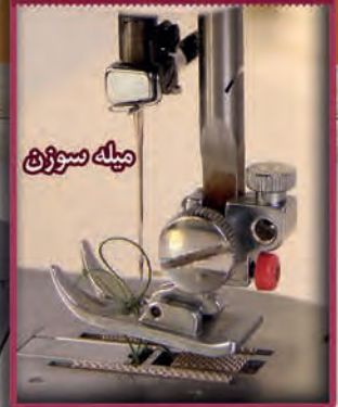
میله نگهدارنده سوزن
