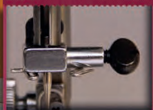
پیچ شل کننده سوزن
