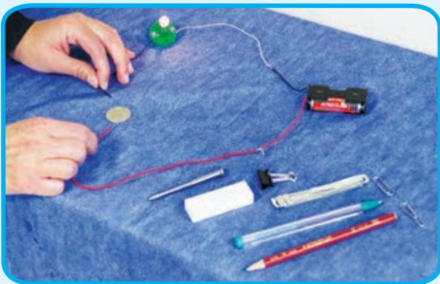
۲- در قسمتی از مدار، بین دو سیم، جسم‌های مختلفی مثل میخ، سکه، پاک‌کن، خط‌کش پلاستیکی، خط‌کش فلزی، عروسک، لیوان پلاستیکی، خط‌کش چوبی و گیره‌ی کاغذ قرار دهید.
