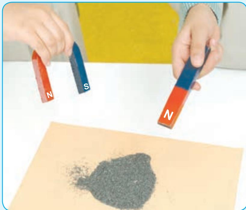
به قسمتی از آهن ربا که خاصیت آهنربایی بیشتری دارد، قطب آهن ربا می‌گویند. هر آهن ربا دو قطب دارد.
