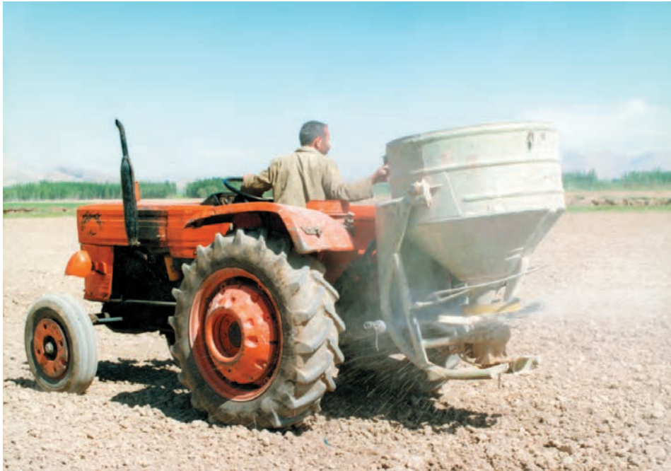
شکل ۸-۴- پخش کود شیمیایی به وسیله کودپاش ساتریفورژ
