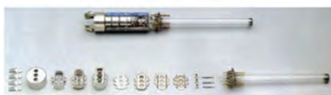
شکل ۱-۷- اجزای یک تفنگ الکترونی
