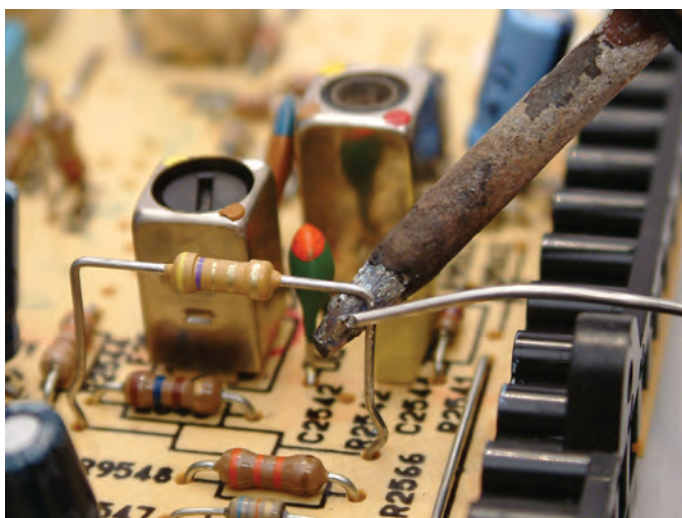
شکل ۲-۳۰- لحیم‌کاری مجدد پایه قطع شده قطعه پس از اتمام کار
