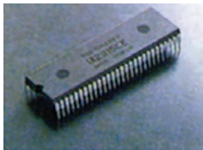
شکل ۱۰۹-۲ یک آی‌سی PROM
