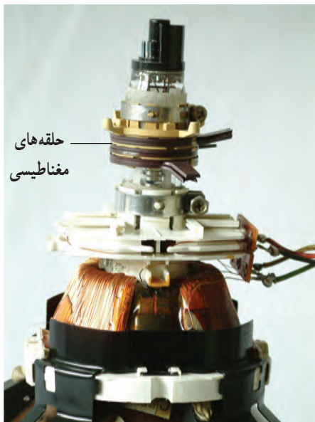
شکل ۹۸-۱- حلقه های مغناطیسی روی گردن لامپ
