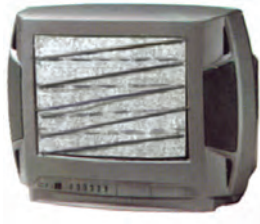
شکل ۱۱۰-۱ خطوط برگشت رؤیت می شود.
