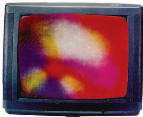
شکل ۸۰-۱- عدم ایجاد خلوص رنگ
