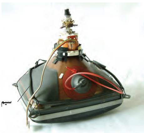
شکل ۱-۲۰۰ محل قرار گرفتن سیم پیچ مغناطیس زدا
