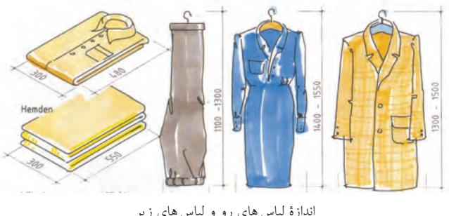
شکل (۳-۲۷) اندازه اشیای مختلف که در داخل مبلهای قرار داده می‌شوند.
