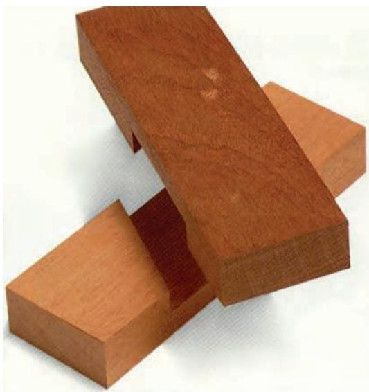
شکل (۱۶۱-۳) تصویر مجسم اتصال متقطع با زاویه کمتر از ۹۰ درجه (نیم نیم)
