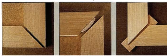
اتصال گوشه‌ای قلیف زبانه اتصال گوشه‌ای بیسکویتی دو رو فارسی اتصال گوشه‌ای دو رو فارسی جدا دو رو فارسی
