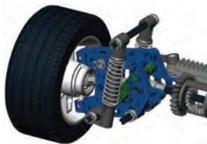
شکل ۲-۱۴ فنرهای به کار رفته در چرخ‌های خودرو
