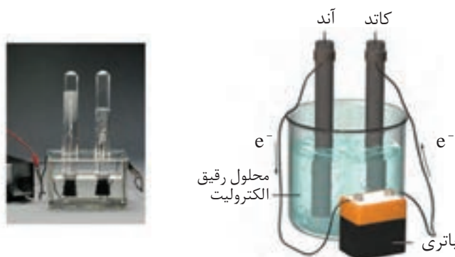
شکل ۱۱- تجزیه آب به گازهای هیدروژن و اکسیژن با مصرف انرژی الکتریکی
