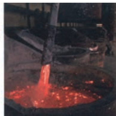
شکل ۱۸- فرایند هال برای تولید آلومینیم از \text{Al}_2\text{O}_3
