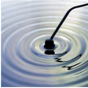
شکل ۱۶-۳ تشکیل امواج دایره‌ای بر سطح آب یک تشت موج
