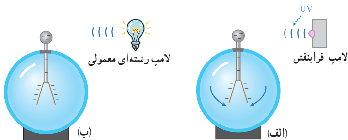
شکل ۱-۴ الف) برهم‌کنش نور فرودی فرابنفش با کلاهک برق‌نما سبب می‌شود تا ورقه‌های آن به سرعت به هم نزدیک شوند. ب) در حالی که برهم‌کنش نور مرئی گسیل شده از یک لامپ رشته‌ای تغییراتی در انحراف ورقه‌های برق‌نما به وجود نمی‌آورد.
