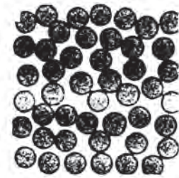
بتن اسفنجی (مواد تولیدکننده‌ی گاز در داخل بتن آماده)
