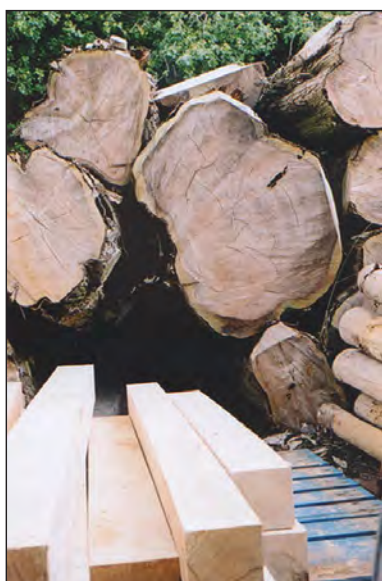
شکل ۱-۱۵۹ بالای تصویر گرده بینه - پایین تصویر الوار
