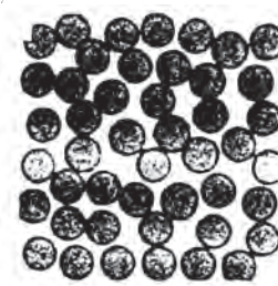
بتن اسفنجی (مواد تولیدکننده‌ی گاز در داخل بتن آماده)
