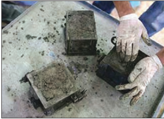
شکل ۱-۵۱ آزمایش مقاومت بتن
