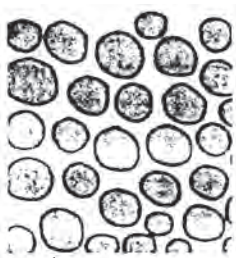
بتن با دانه بندی سبک (سنگ دانه‌ای متخلخل)
