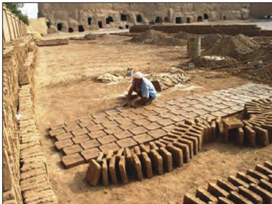
شکل ۱-۵۴ خشت خام (ساخت آجر به روش دستی)
