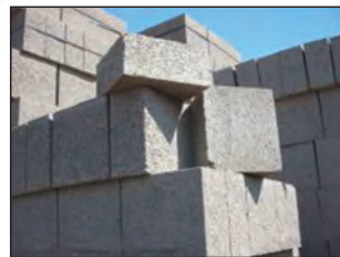
شکل ۷۹-۱ انواع بلوک بتنی سبک
