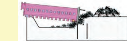
۵- سقوط ساختمان به طور یکپارچه و بدون از هم گسیختگی ترکیب ساختمان
