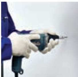
برای نصب پانل‌ها از پیچ مخصوص استفاده می‌شود نحوه صحیح در دست گرفتن پیچ گوشتی برقی اجرای پانل‌ها در یک طرف دیوار
