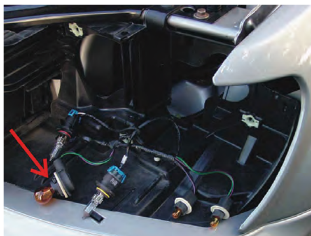
شکل ۱-۵۱ لامپ چراغ‌های روشنایی در یک نوع خودرو
