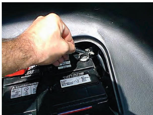
شکل ۱-۵۲ باز کردن بست ترمینال منفی باتری
