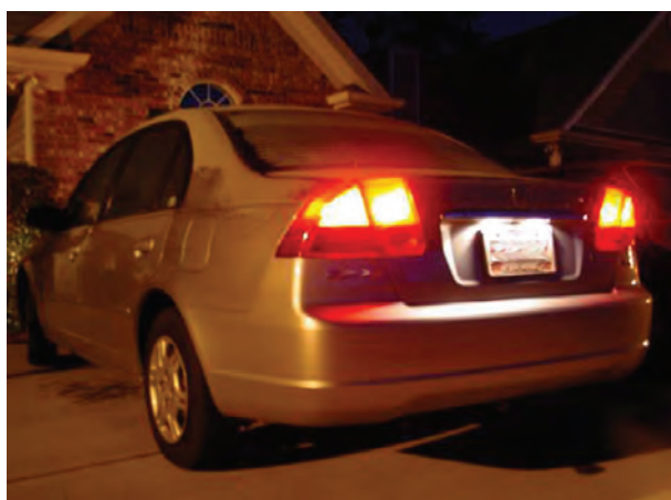
شکل ۱-۲۱- چراغ‌های پلاک خودرو در حالت روشن
