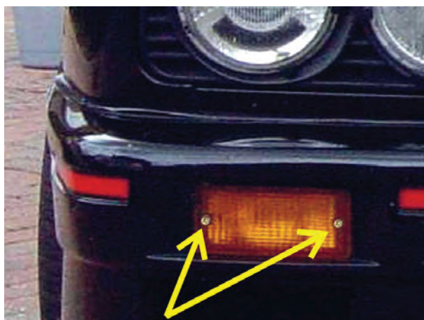
شکل ۱-۵۰ پیچ‌های اتصال تلق چراغ راهنما
