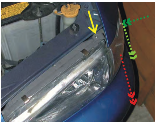
شکل ۱-۳۸- نحوه‌ی جدا کردن چراغ جانبی روشنایی
