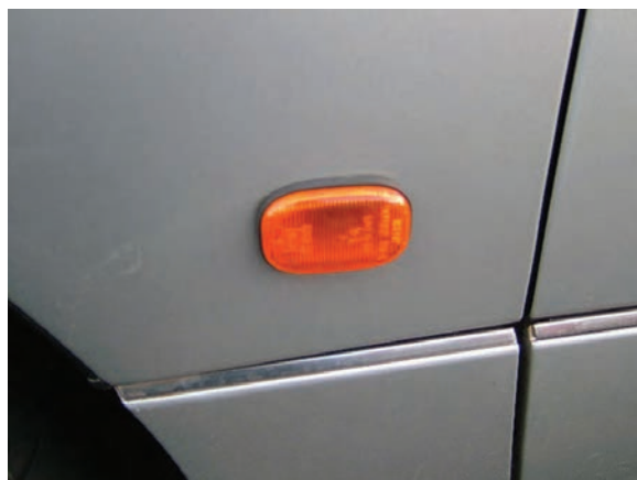
شکل ۱-۶۵ چراغ راهنمای بغل در یک نوع خودرو
