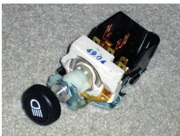
شکل ۱-۷۱- سوئیچ چراغ‌های روشنایی نوع چرخشی
