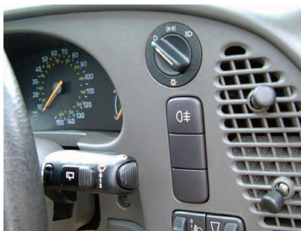
شکل ۱-۶۹- یک نوع سوئیچ روشنایی
