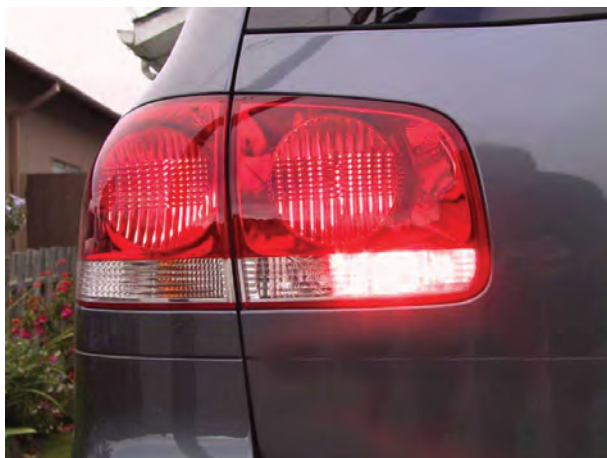
شکل ۱۷-۱ چراغ دنده عقب در وضعیت روشن
