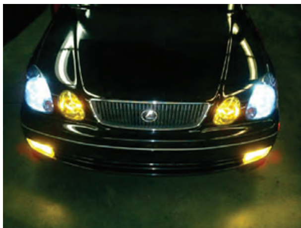
ب - چراغ‌های مه شکن در حالت روشن بودن آن‌ها شکل ۱-۷ - چراغ‌های مه شکن در خودروهای سواری
