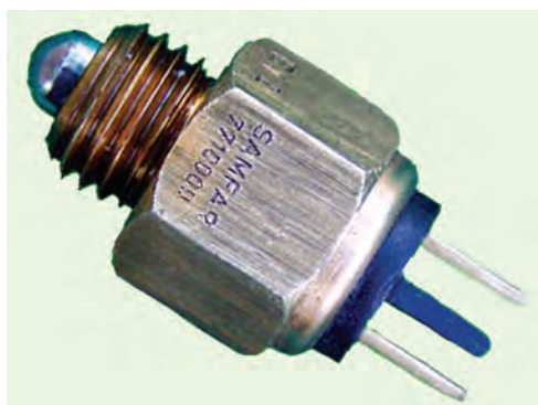
شکل ۱-۷۸- سوئیچ چراغ‌های دنده عقب
