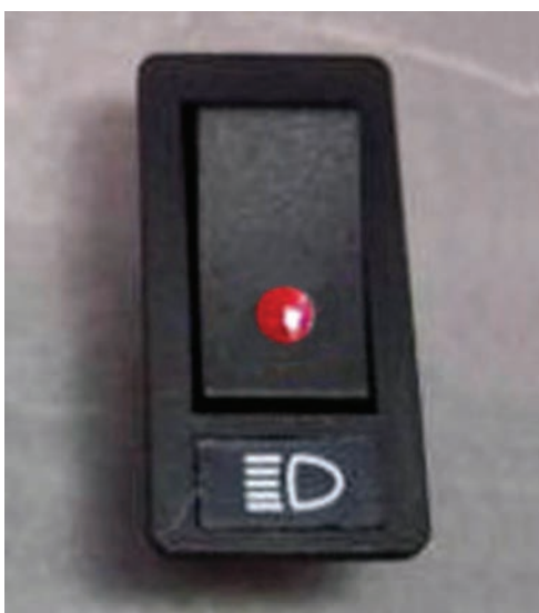
شکل ۸۱-۱- سوئیچ چراغ‌های جانبی (پارک)
