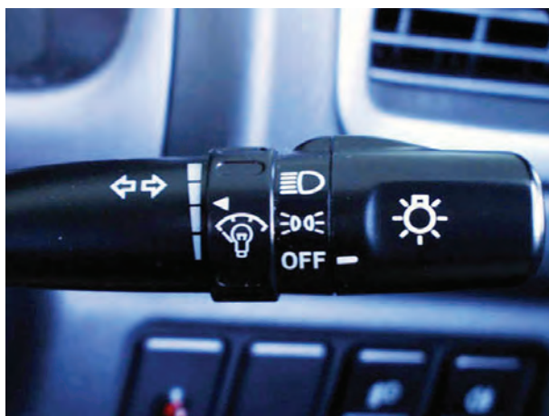
شکل ۱-۷۲- سوئیچ چراغ‌های روشنایی (طرح دسته‌ی راهنما)
