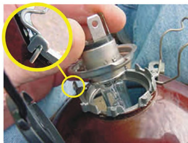
شکل ۱-۴۳- نحوه‌ی ثابت شدن لامپ درون کاسه‌ی چراغ
