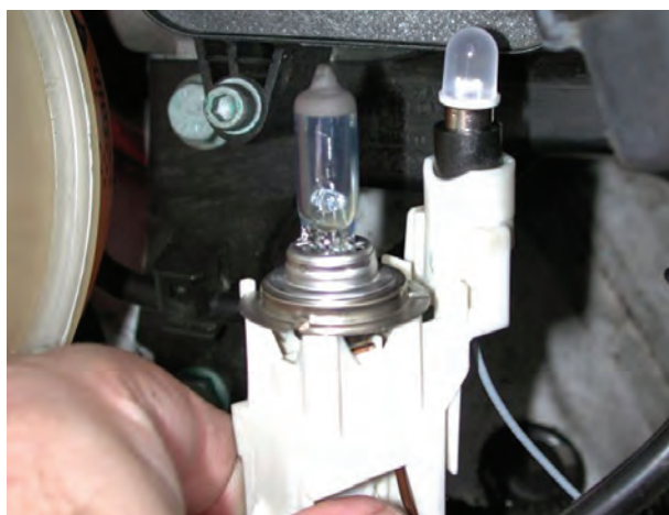
شکل ۱-۴۹ - پایه‌ی مشترک لامپ‌های چراغ روشنایی و پارک
