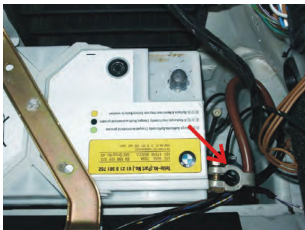
شکل ۳۵-۱- جدا کردن بست اتصال کابل بدنه‌ی باتری
