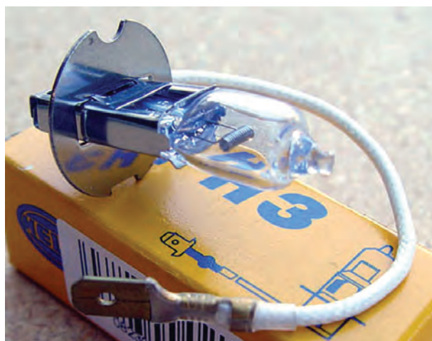
شکل ۱-۳۱- لامپ مورد استفاده در چراغ‌های مه‌شکن، نورافکن‌ها
