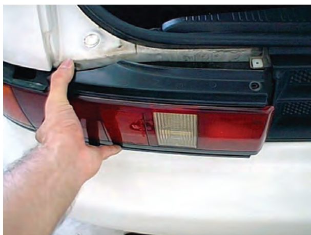
شکل ۱-۵۸- جدا کردن چراغ عقب از بدنه‌ی خودرو
