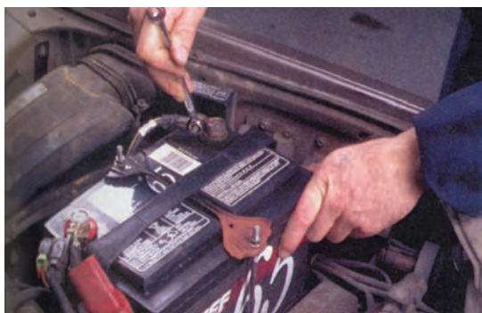
شکل ۱-۹۵- اتصال کابل‌های مثبت و منفی باتری
