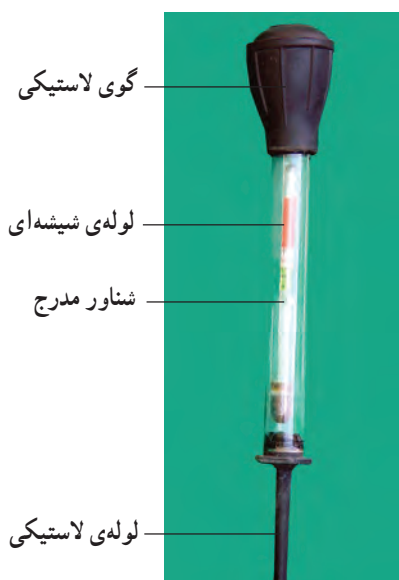
شکل ۱-۱۴- دو نوع هیدرومتر یا چگالی سنج
