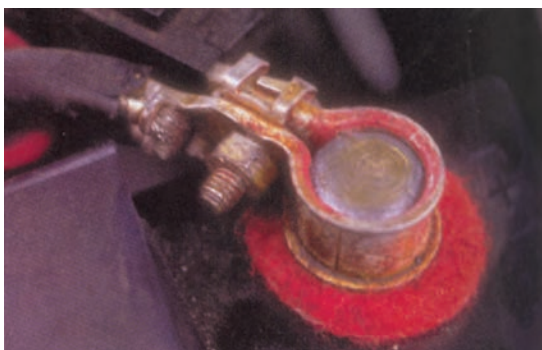
شکل ۱-۹۷- گریس زدن بست قطب‌ها
