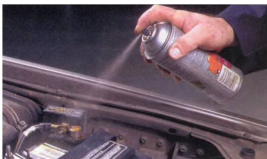
شکل ۱-۹۶- پاشیدن محلول ضد خوردگی روی بست
