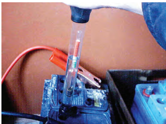
شکل ۱-۶۲- کنترل غلظت الکترولیت
