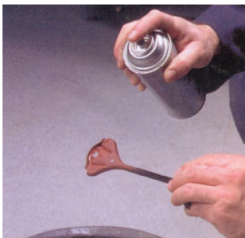
شکل ۹۳-۱- اسپری ضدخوردگی روی بست نگه‌دارنده‌ی باتری
