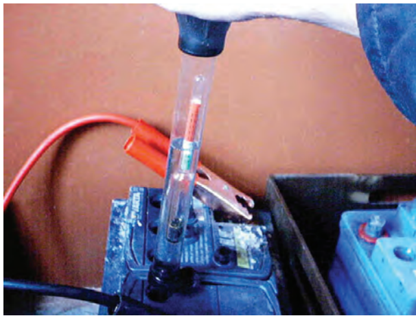
شکل ۱-۵۳- کنترل غلظت الکترولیت
