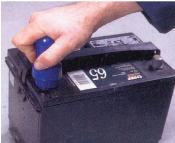
شکل ۸۹-۱ - نحوه‌ی استفاده از ابزار مخصوص باتری
