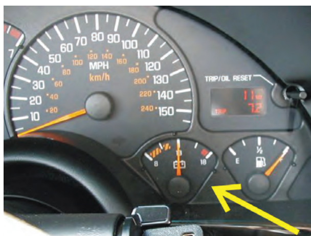
شکل ۱-۷۸ – نشان‌دهنده‌ی وضعیت شارژ باتری
