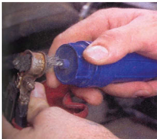
شکل ۹۱-۱ - پاک کردن بست‌های باتری با برس سیمی
