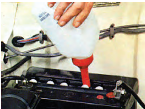
شکل ۱-۷۴- کنترل سطح الکترولیت
