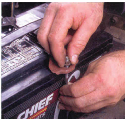
شکل ۹۴-۱- بستن باتری روی خودرو
