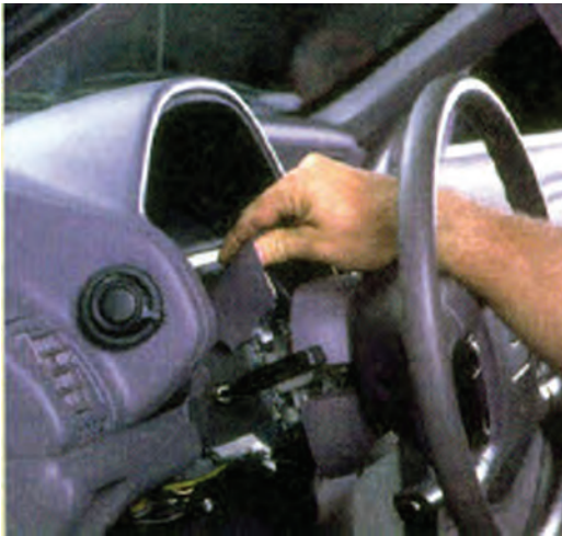
شکل ۹۱-۱- بیرون آوردن قاب سوئیچ روشنایی
