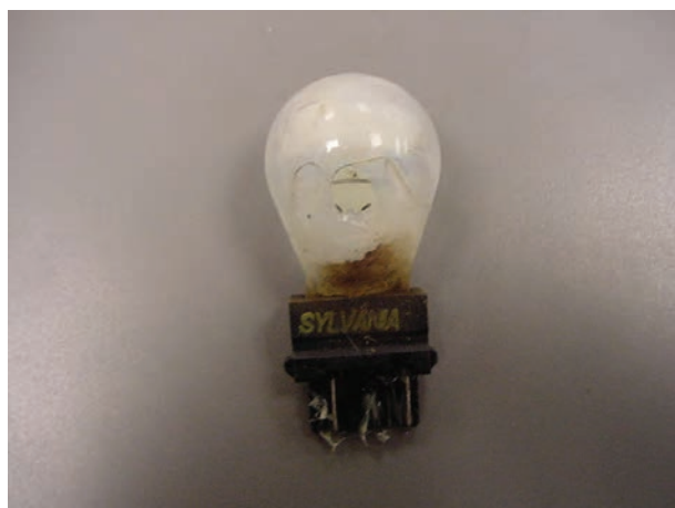
شکل ۱۴۱-۱- اثر عوامل فیزیکی در معیوب شدن لامپ
