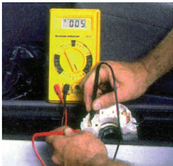
شکل ۹۷-۱- آزمایش سوئیچ روشنایی
