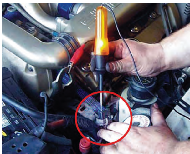
شکل ۱-۱۴۵- آزمایش برقراری جریان مدار چراغ‌های روشنایی
