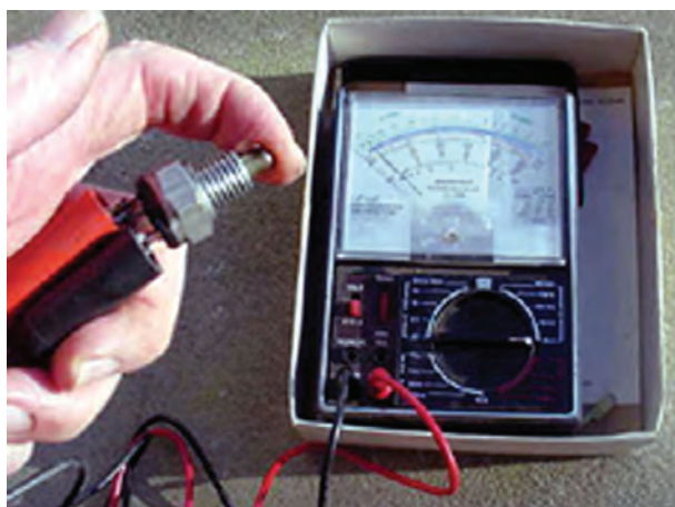
شکل ۱۰۵-۱- آزمایش سوئیچ چراغ‌های دنده عقب
