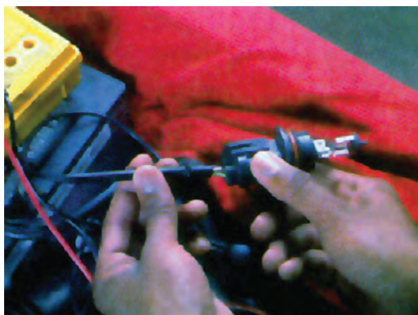
شکل ۱۴۲-۱- آزمایش لامپ چراغ‌های بزرگ جلو
