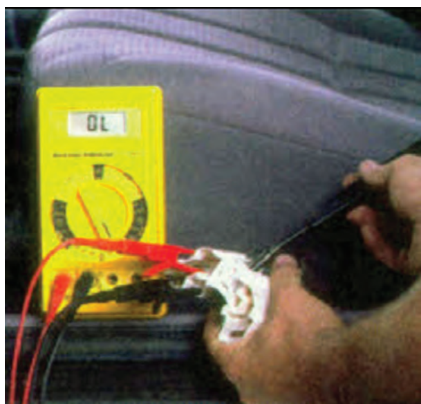
شکل ۹۸-۱- آزمایش حالت استپ موقت دسته ی راهنما
