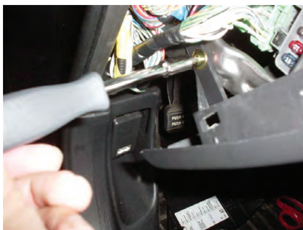
شکل ۱-۸۴- باز کردن پیچ اتصال قاب زیرین به بدنه
