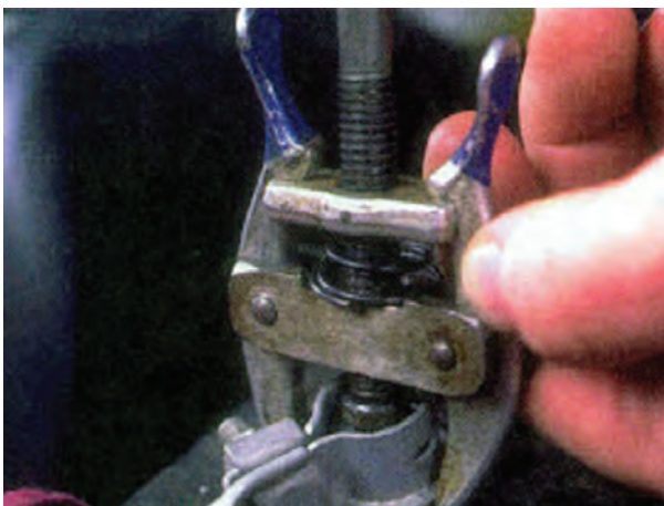
شکل ۱-۸۹- باز کردن بست اتصال بدنه‌ی باتری
