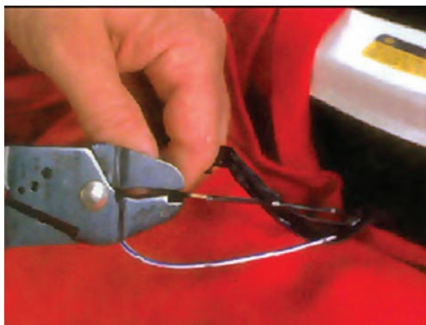
شکل ۱۴۶-۱- استفاده از انبر مخصوص برای قطع سیم
