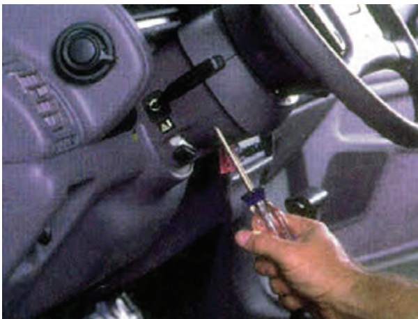
شکل ۱-۹۰- باز کردن پیچ‌های قاب سوئیچ روشنایی
