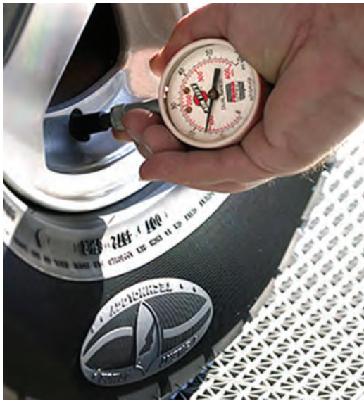
شکل ۱۵۸-۱- کنترل فشار باد تایر
