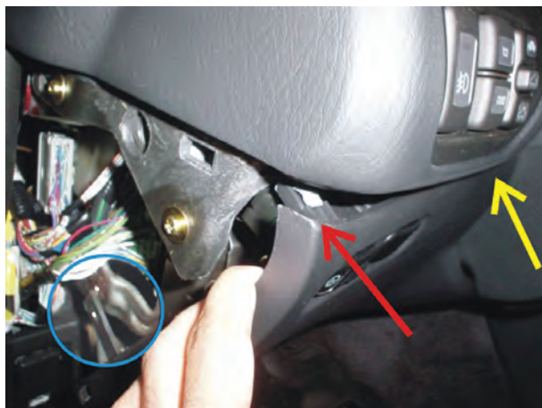
شکل ۱-۸۵- خارج کردن قاب از روی بدنه‌ی پانل
