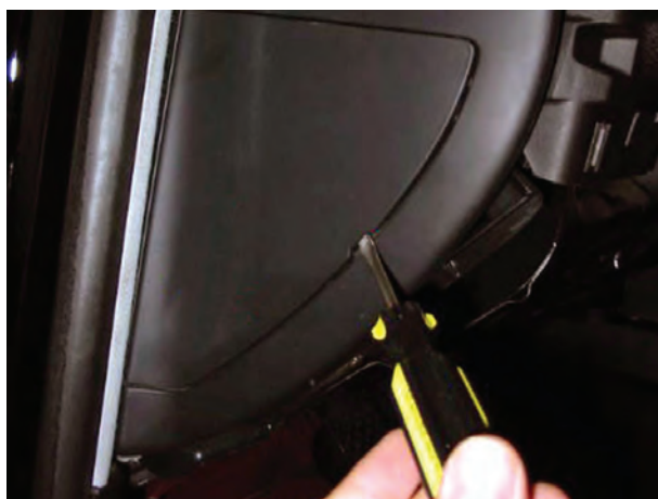
شکل ۱۱۸-۱- آزاد کردن خار پوشش محافظه‌ی جعبه‌ی فیوز
