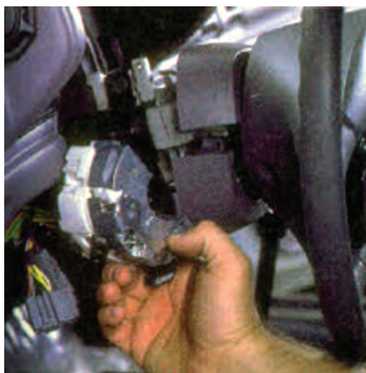
شکل ۱-۹۶- خارج کردن سوئیچ روشنایی از محل خود
