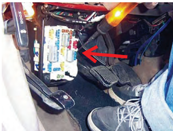
شکل ۱۲۰-۱- آزمایش جعبه‌ی فیوز با چراغ آزمایش
