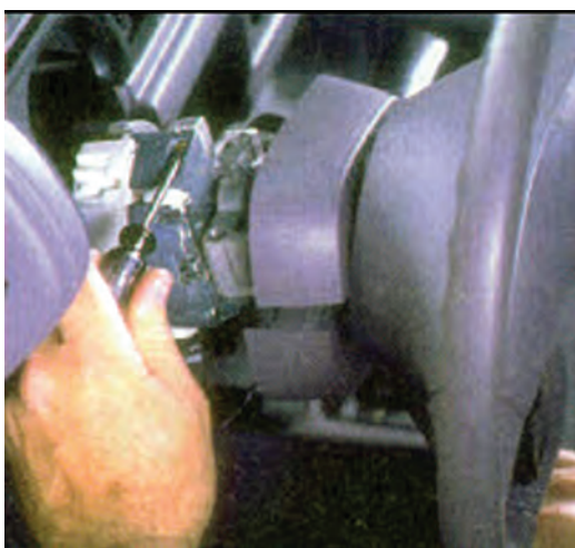
شکل ۱-۹۵- باز کردن پیچ بدنه سوئیچ روشنایی
