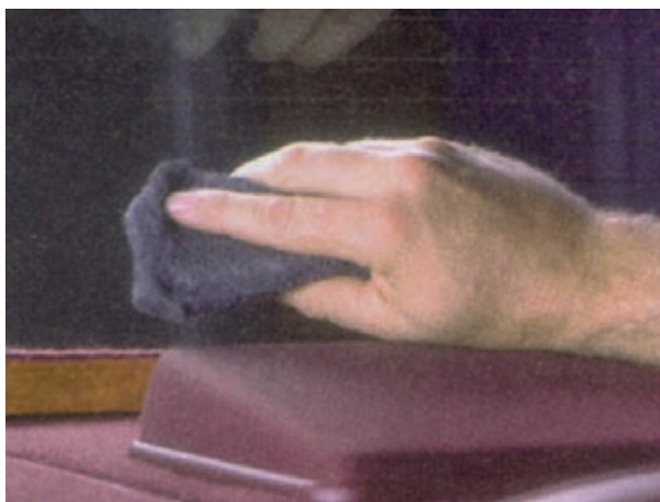
شکل ۲۲-۳- تمیز کردن محل قطع شده‌ی المنت حرارتی
