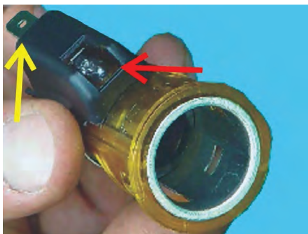
شکل ۱-۲۲۴- لامپ فندک و ترمینال الکتریکی آن
