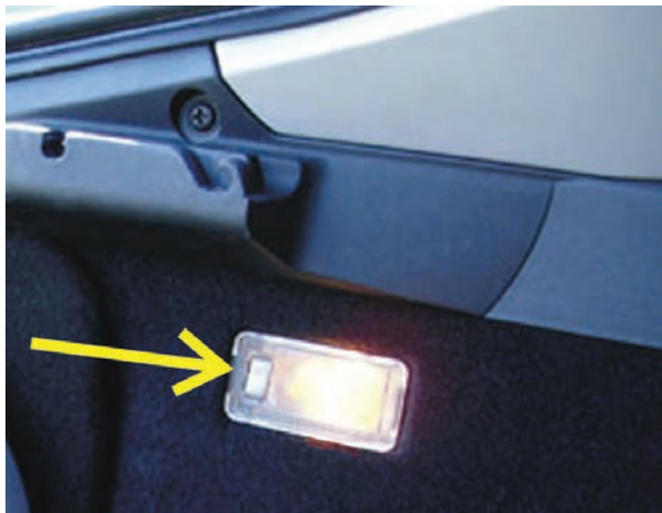
شکل ۲۱۸-۱- چراغ صندوق عقب و سوئیچ روی آن
