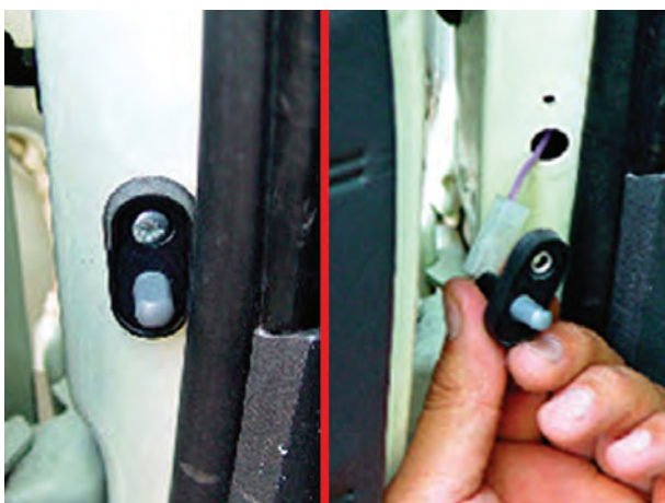
شکل ۱۹۲-۱- باز کردن سوئیچ لای در
