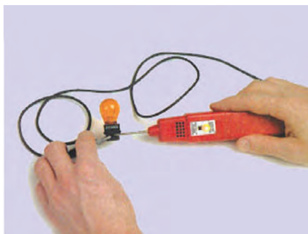
شکل ۱۸۲-۱- آزمایش لامپ چراغ راهنما
