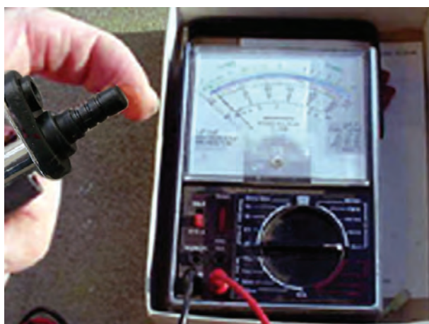
شکل ۱۹۶-۱- آزمایش سوئیچ لای در
