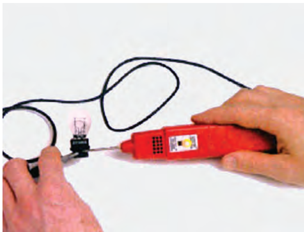
شکل ۲۱۹-۱- آزمایش لامپ چراغ صندوق عقب خودرو
