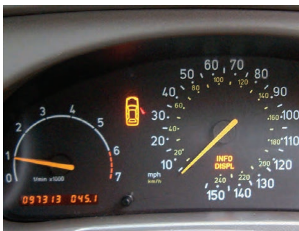
شکل ۲۱۳-۱- چراغ اخطار بازبودن درهای خودرو
