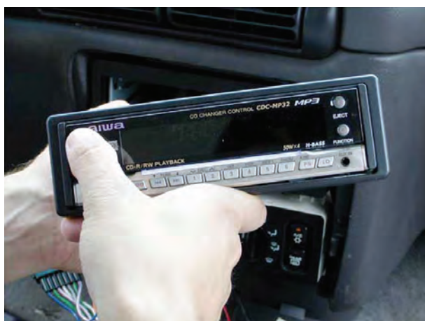
شکل ۲۸-۴- خارج نمودن رادیوپخش از داخل قاب کشویی
