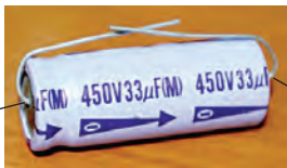
الف - توجه به قطب‌های خازن الکترولیتی
