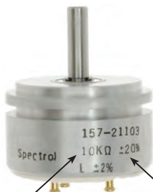
تولرانس 20\% درصد مقدار مقاومت 10 کیلو اهم است
