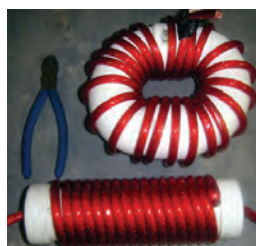
سلف پیچیده شده روی قرقره بدون هسته
