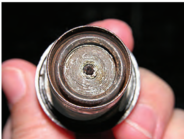
شکل ۱-۲۲۵- المنت حرارتی داخل سوئیچ فشاری
