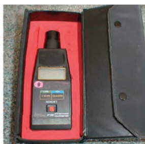
دورسنج دیجیتالی با محرک مکانیکی
