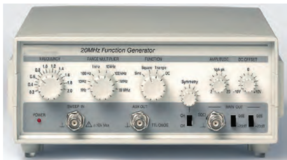
شکل ۵-۲- دو نمونه سیگنال ژنراتور AF
