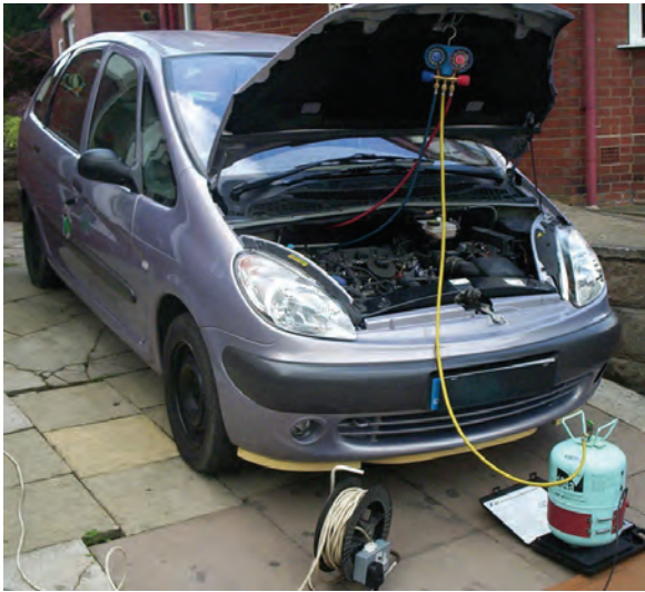
شکل ۳۵-۵ شارژ گاز کولر
