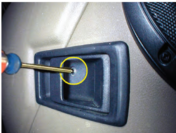
شکل ۳۶-۲- باز کردن قاب دستگیره‌ی قفل در
