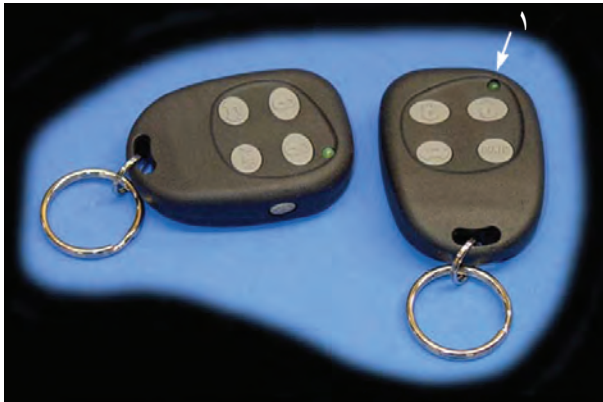
۱- دیود نوری نشان‌دهنده‌ی ارسال سیگنال شکل ۵۹-۲- فرستنده یا ریموت کنترل
