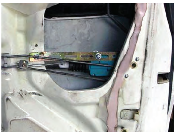
شکل ۳۷-۲- نحوه‌ی اتصال عملگر الکتریکی
