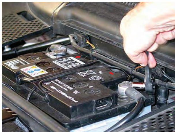
شکل ۲-۳۳- باز کردن اتصال بدنه‌ی باتری
