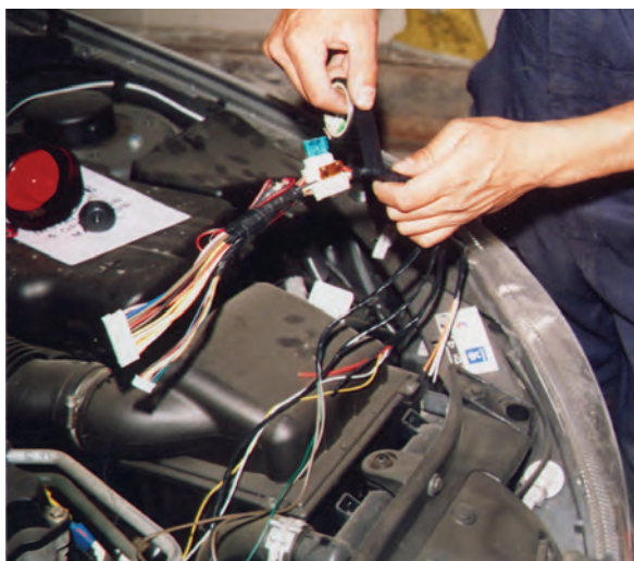
شکل ۲-۷۷- نحوه‌ی عایق‌بندی سیم‌های مدار الکتریکی دزدگیر
