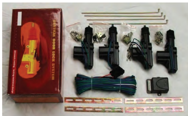
ب – اجزای سیستم قفل مرکزی شکل ۲-۵۲ – جعبه‌ی ابزار و اجزای یک نوع سیستم قفل مرکزی
