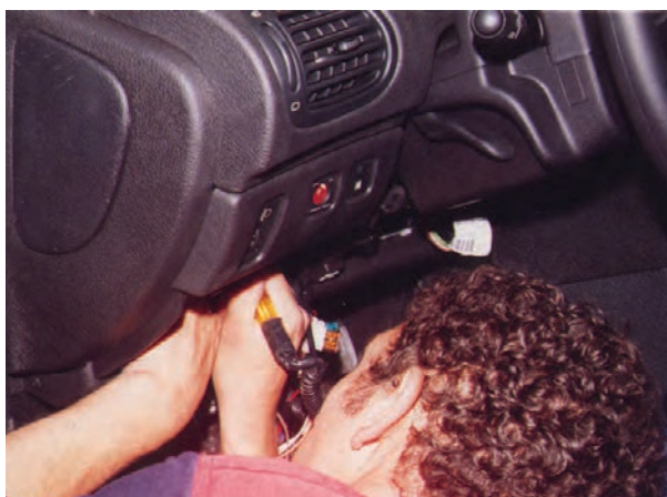
شکل ۲-۹۵- آزمایش برقراری جریان الکتریکی مدار
