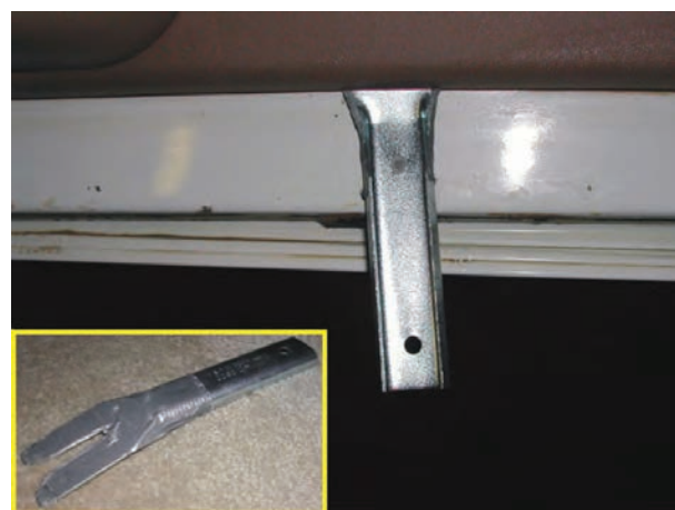
شکل ۲-۳۵- اهرم خاردرآر و نحوه‌ی استفاده از آن
