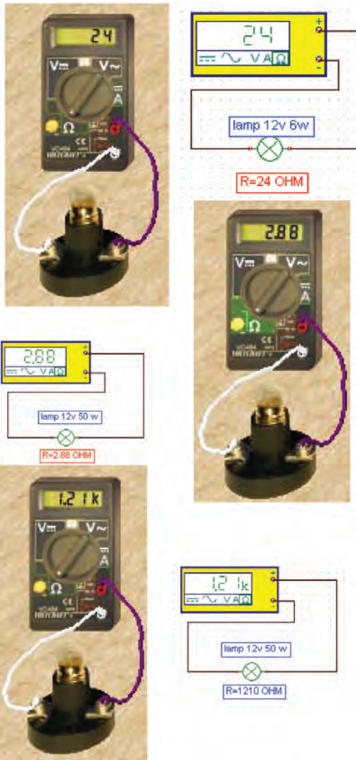
شکل ۸۹-۲- اندازه گیری مقاومت لامپ‌های روشنایی
