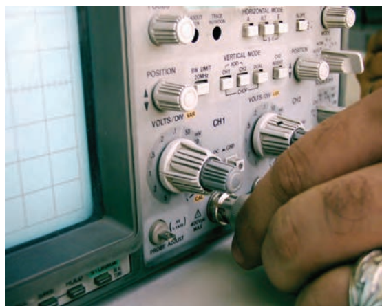
شکل ۱۱۴-۲ نحوه‌ی اتصال BNC به اسیلوسکوپ
