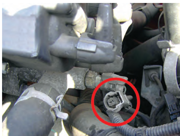
شکل ۱۶-۶ جدا کردن سوکت اتصال
