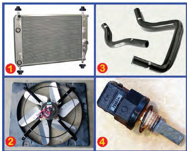
شکل ۲-۶- اجزای مدار خنک کاری
