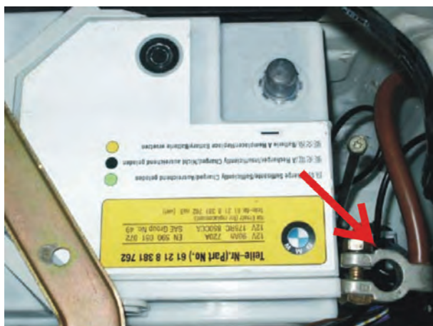
شکل ۲-۱۰۹- باز کردن اتصال منفی باتری
