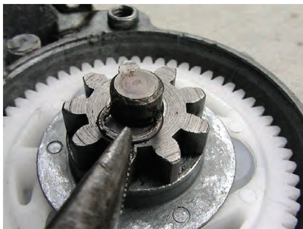
شکل ۱۲۹-۲ جانداختن خار فنری
