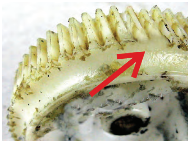
شکل ۱۲۷-۲ وجود عیب در چرخ دنده
