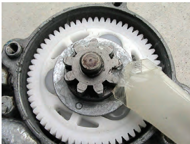
شکل ۱۳۰-۲- روغن کاری چرخ دنده ها
