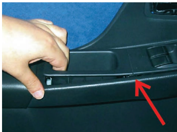
شکل ۱۸۳-۲- خارج نمودن قاب سوئیچ‌ها
