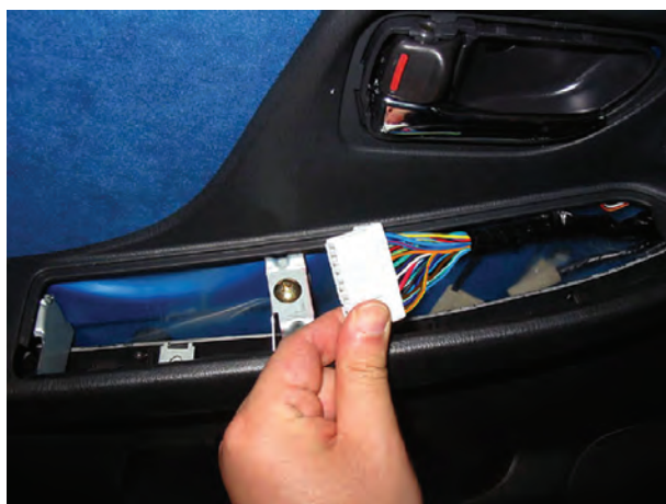
شکل ۱۸۵-۲- سوکت اتصال دسته سیم به سوئیچ‌ها
