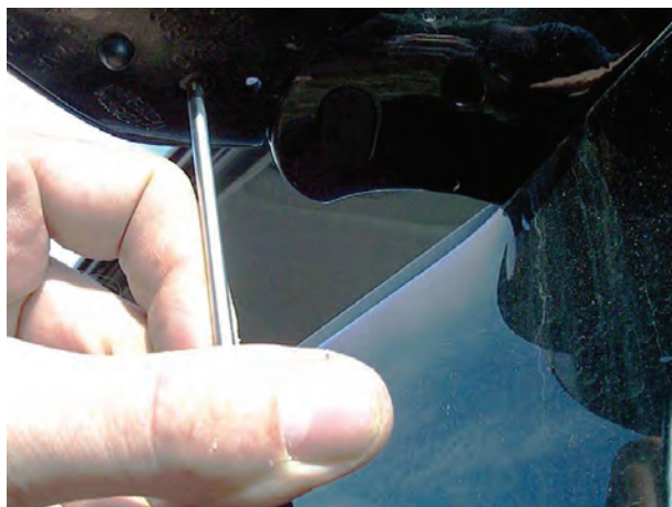
شکل ۱۷۵-۲- بازکردن پیچ پایین قاب بیرونی آینه
