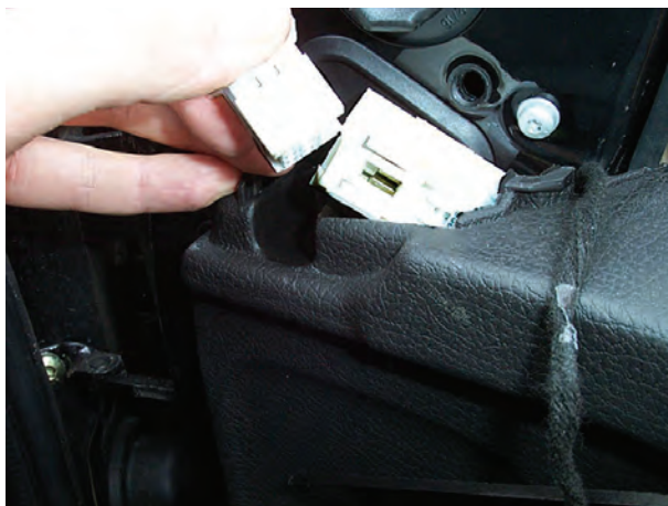
شکل ۱۶۶-۲- جدا کردن سوکت سیم کشی آینه
