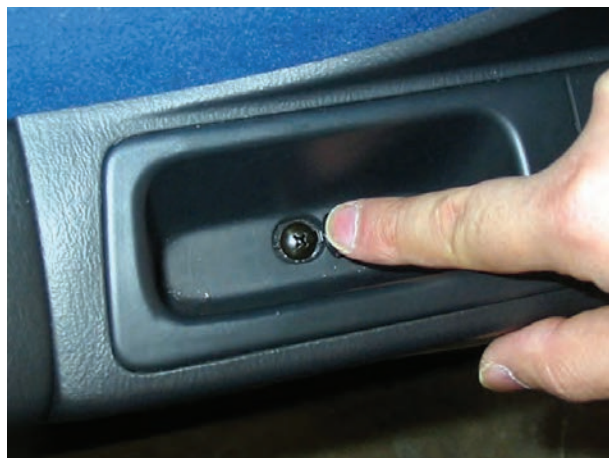
شکل ۱۸۲-۲- پیچ اتصال قاب سوئیچ به بدنه
