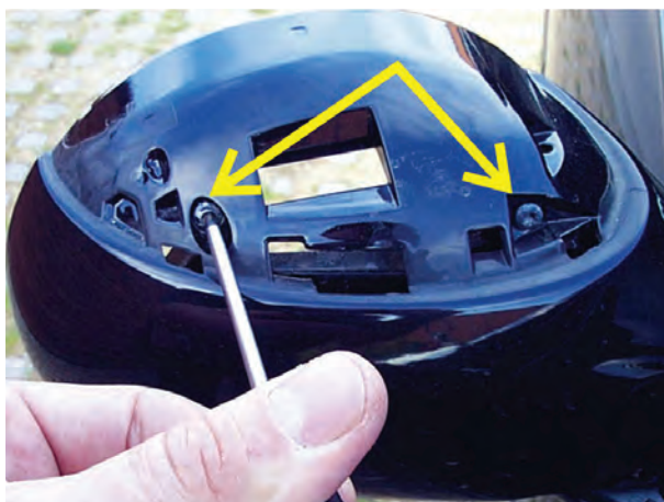
شکل ۱۷۴-۲- بازکردن پیچ‌های قاب بیرونی آئینه
