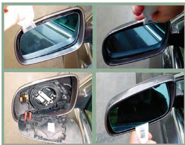
شکل ۱۶۷-۲- بیرون آوردن آینه از داخل قاب آن
