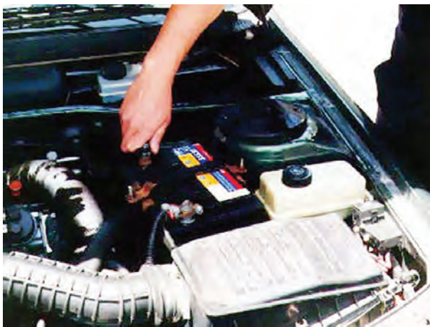
شکل ۱۶۴-۲ بازکردن کابل اتصال بدنه‌ی باتری
