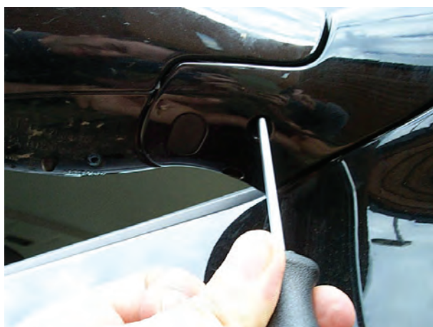
شکل ۱۷۶-۲- بازکردن پیچ روی پایه ی بیرونی آینه
