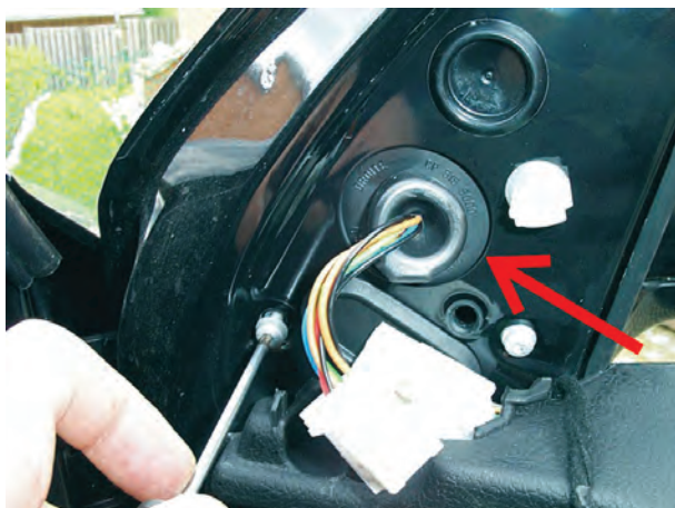
شکل ۱۷۸-۲- باز کردن پیچ دارنده‌ی پایه‌ی اصلی آینه
