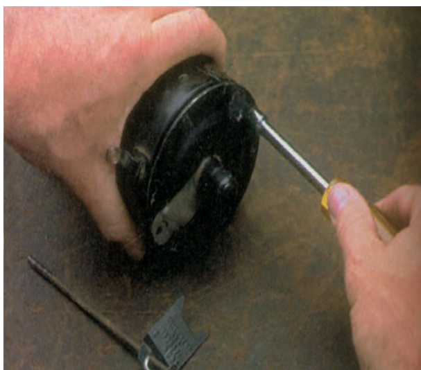
شکل ۸-۵۵ - باز کردن پیچ‌های اتصال درپوش به بدنه
