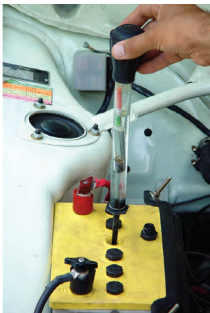
شکل ۲۸-۸ - بررسی دشارژ باتری
