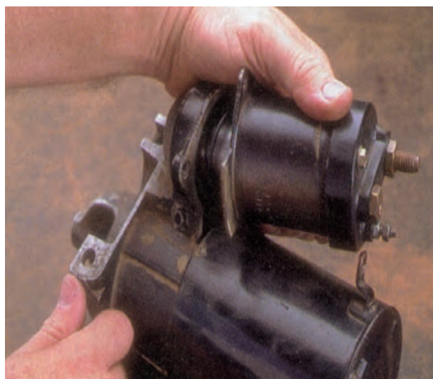
شکل ۸-۵۴ - خارج کردن اتومات
