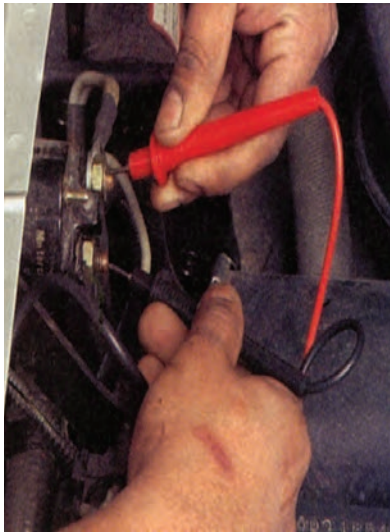
شکل ۸-۴۲- اتصال فیض‌های ولت‌متر به اتومات استارتر
