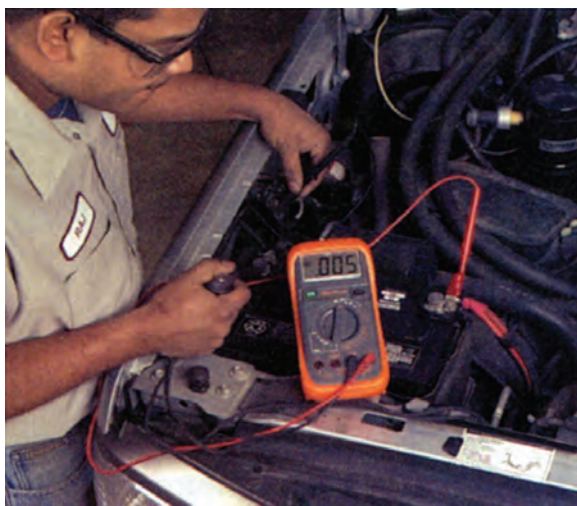
شکل ۸-۴۰- اتصال سیم منفی ولت‌متر به ورودی رله
