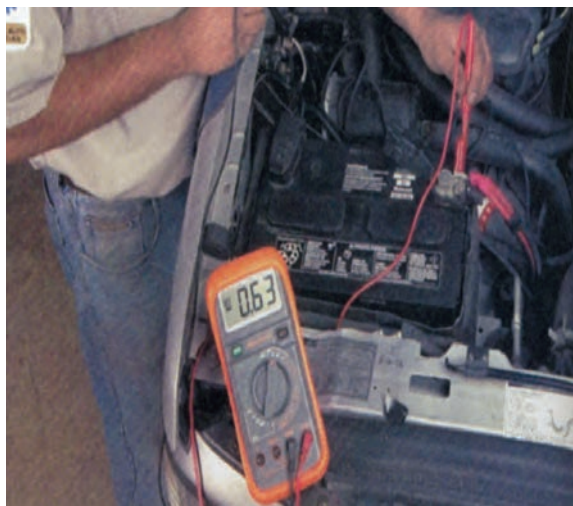
شکل ۸-۳۸ – اتصال فیش سیم منفی ولت‌متر به محل کابل رله‌ی استارتر
