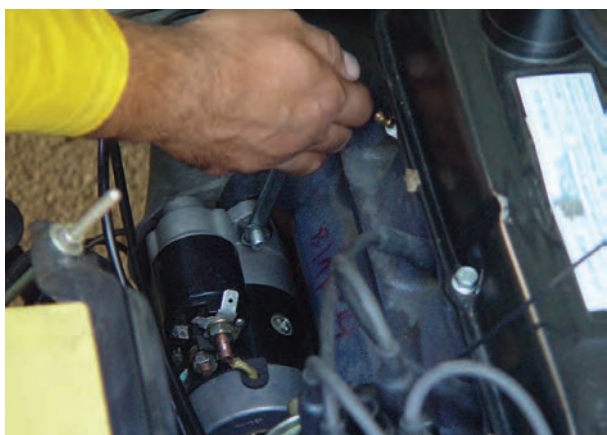
الف- باز کردن پیچ‌های استارتر
