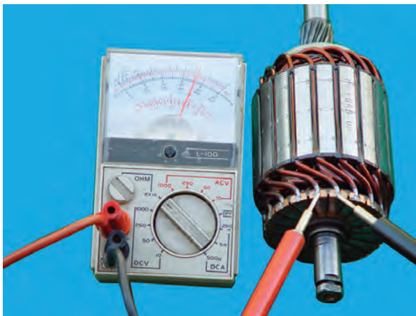
شکل ۶۶-۸- آزمایش سیم پیچ‌های آرمیچر – سالم بودن سیم‌ها و اتصال به لامل‌ها
