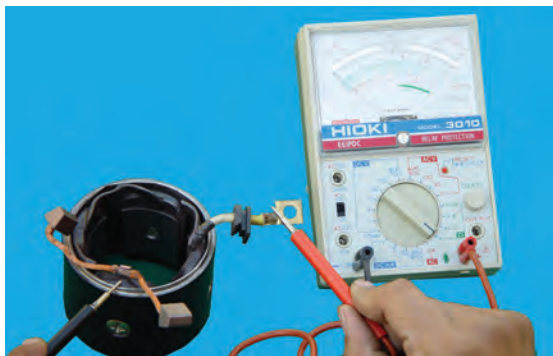
شکل ۸-۷۵- آزمایش اتصال بدنه‌ی بالشتک
