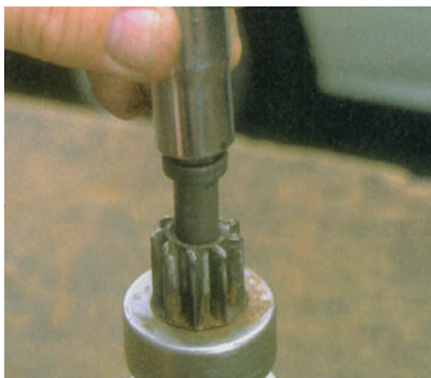
شکل ۸-۶۰ – خارج کردن حلقه رینگی از شیار شافت
