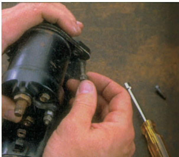
شکل ۸-۵۳ - بیرون آوردن پیچ‌های اتومات
