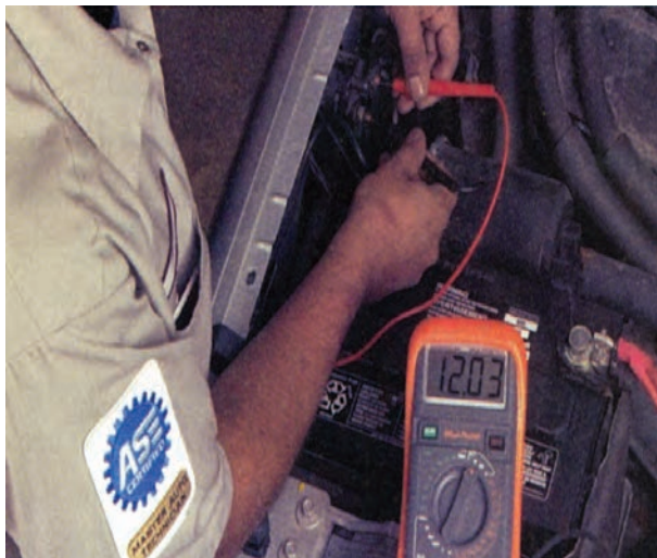
شکل ۸-۴۳- ولتاژ روی ولت‌متر
