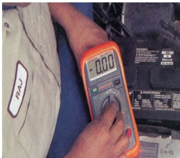
شکل ۸-۳۵- تنظیم مولتی متر روی شاخص ولتاژ
