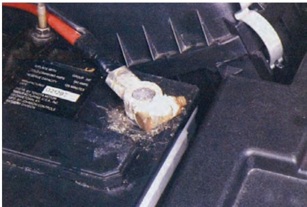
شکل ۳۱-۸ سولفات‌ها شدن اتصال قطب باتری
