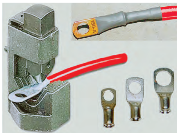
شکل ۸۰-۸- اتصال بست به کابل باتری
