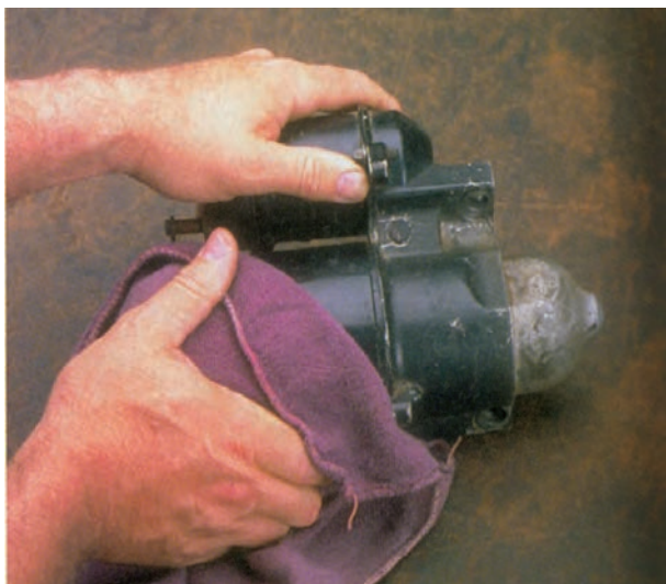
شکل ۸-۵۰ - تمیز کردن استارت
