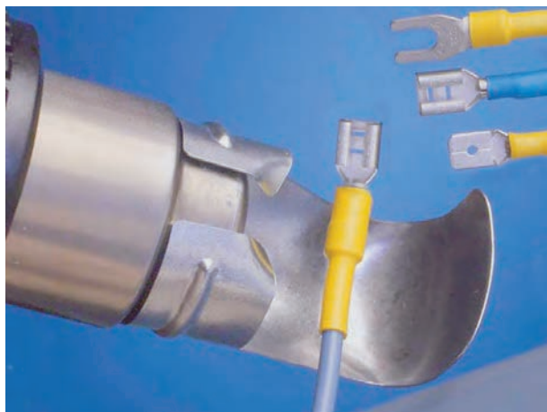
شکل ۷۹-۸- عایق‌کاری اتصال سرسیم به سیم
