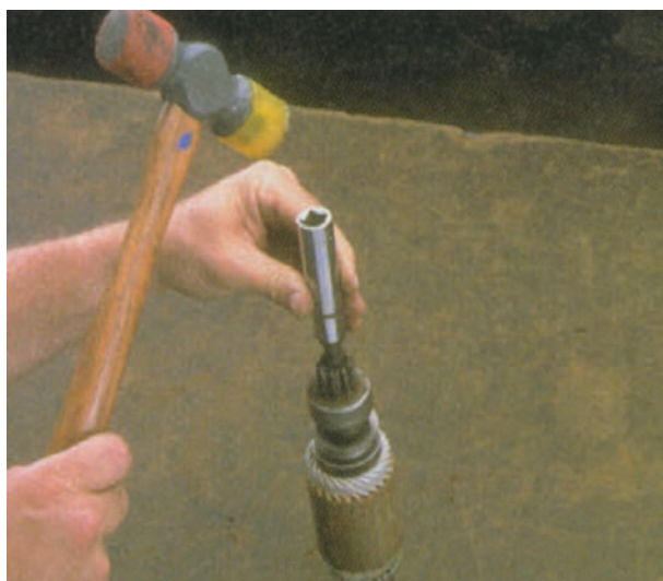
شکل ۸-۵۹ – ضربه زدن با چکش روی خار
