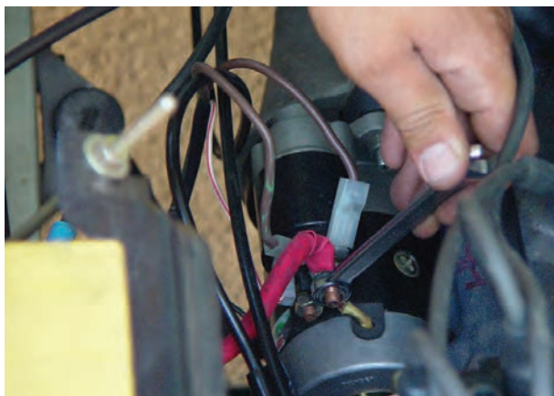
شکل ۸-۴۸- جدا کردن اتصالات الکتریکی استارت
