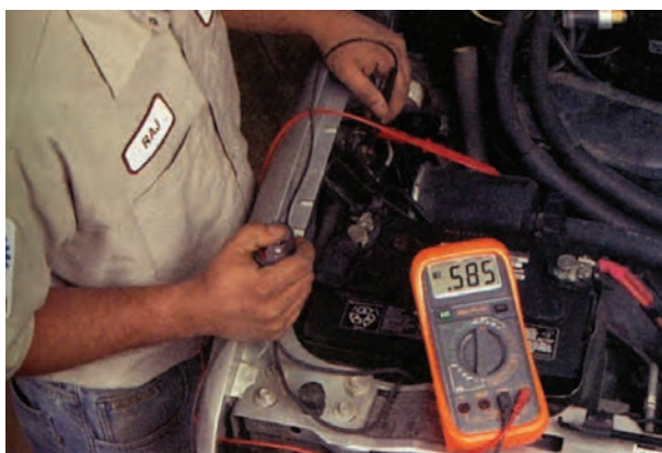
شکل ۸-۴۴- اندازه‌گیری افت ولتاژ پلاتین‌های سولونویید استارتر
