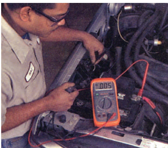
شکل ۸-۴۱- اندازه‌گیری افت ولتاژ کابل متصل به رله
