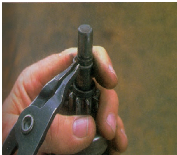
شکل ۸-۶۱ – درآوردن خار رینگی
