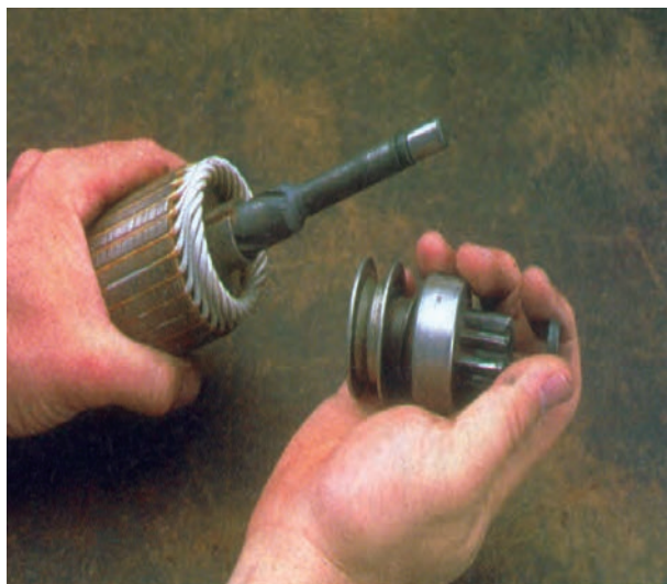
شکل ۸-۶۲ - خارج کردن مجموعه دنده‌ی استارت از روی شافت
