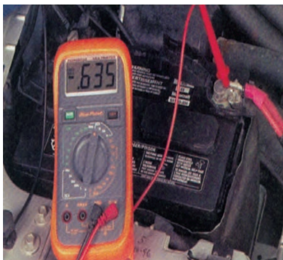
شکل ۸-۳۷ – اندازه‌گیری افت ولتاژ جریان ورودی کابل استارتر
