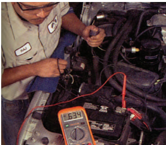
شکل ۸-۳۹- آزمایش افت ولتاژ باتری به خروجی رله
