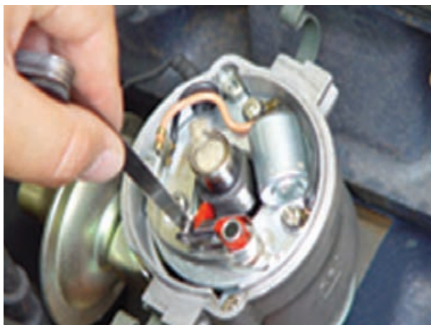
شکل ۴۸-۱۰- قرار دادن فیلر در دهانه‌ی پلاتین
