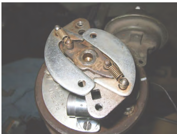
شکل ۲۴-۱۰- دستگاه آوانس وزنه‌ای دلکو
