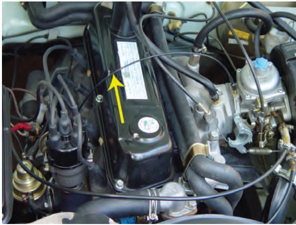
شکل ۲۸-۱۰- لوله‌ی رابط آوانس خلتی به کاربراتور
