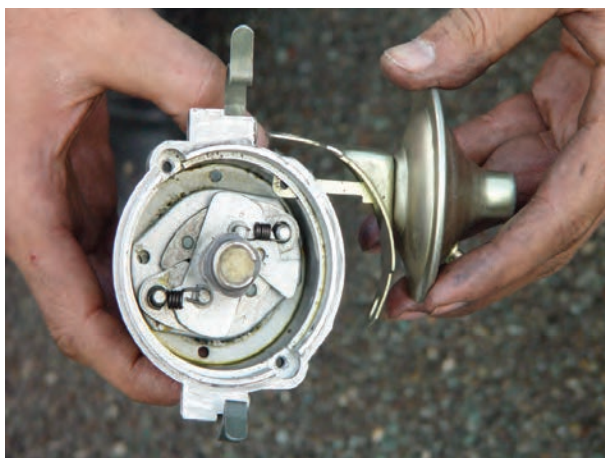
شکل ۳۱-۱۰ جدا کردن مجموعه‌ی آوانس خلئی
