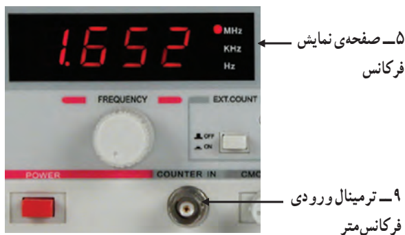
شکل ۲-۱۰۳- فرکانس متر و ترمینال ورودی آن
