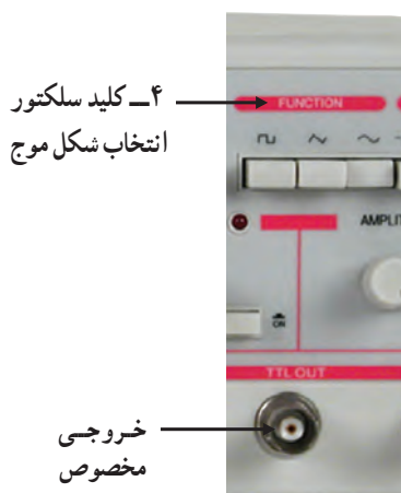
شکل ۲-۱۰۱ کلید سلکتور انتخاب شکل موج
