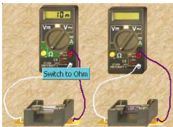
شکل ۸۱-۲ اتصال فیوز به اهم متر
