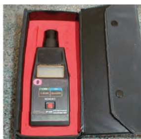
دورسنج دیجیتالی با محرک مکانیکی
