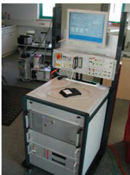
شکل ۲-۱۹۳- دو نمونه دستگاه عیب‌یاب و اسکینر خودرو
