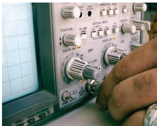
شکل ۱۱۴-۲ نحوه‌ی اتصال BNC به اسیلوسکوپ
