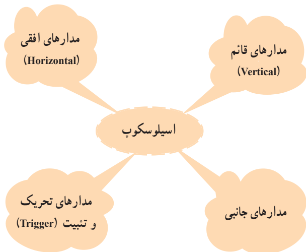
شکل ۱۲۰-۲ مدارهای موجود در اسیلوسکوپ
