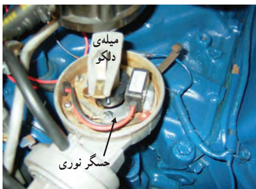
شكل ۲-۱۴۵- سه نمونه حسگر استفاده‌شده در سیستم جرقه‌زنی
