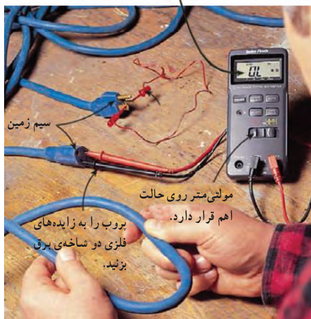
شکل ۲-۸۰ — آزمایش سیم رابط برق دستگاه.
