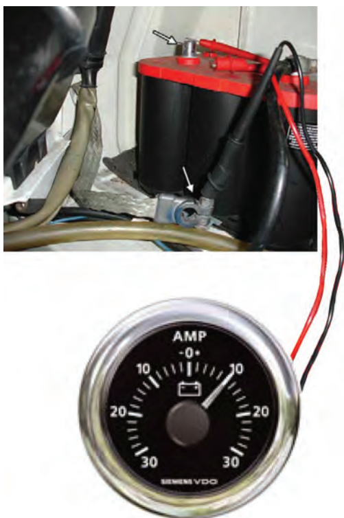
شکل ۱-۵۲ اتصال آمپر متر به صورت سری
