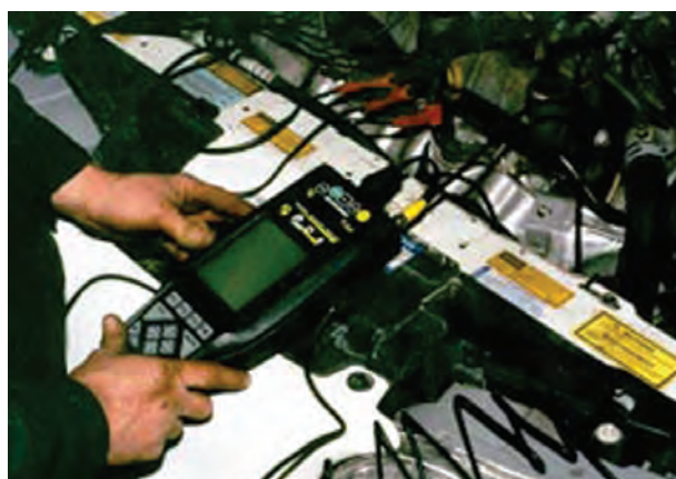
شکل ۲-۱۹۴- یک نمونه دستگاه اسکینر کوچک دستی
