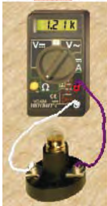
شکل ۸۹-۲ اندازه گیری مقاومت لامپ های روشنایی
