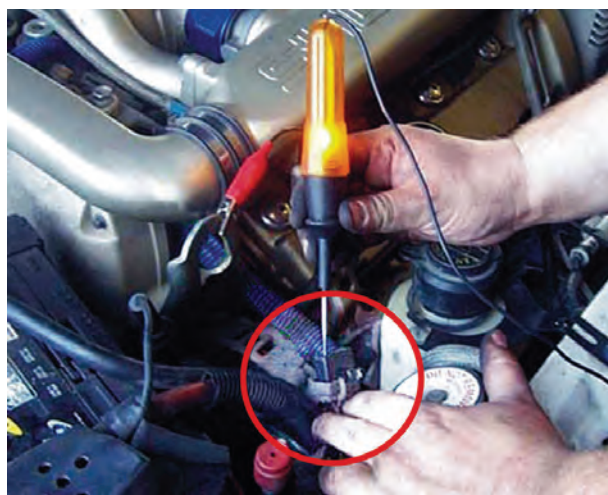
شکل ۱۴۵-۱ آزمایش برقراری جریان مدار چراغ‌های روشنایی
