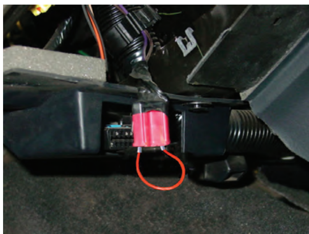
شکل ۱۲۹-۱ یک‌سره کردن مدار راهنما
