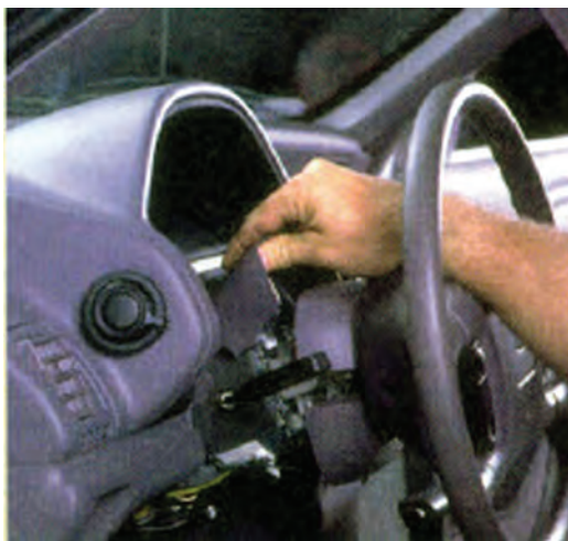
شکل ۹۱-۱- بیرون آوردن قاب سوئیچ روشنایی
