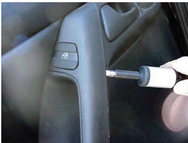
شکل ۱۱-۲- جدا کردن قاب سوئیچ شیشه بالابر
