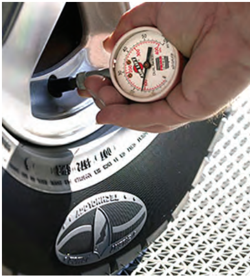
شکل ۱۵۸-۱- کنترل فشار باد تایر
