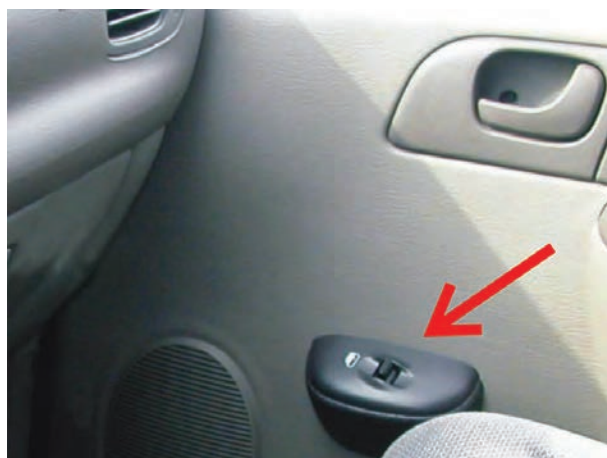
شکل ۱۳۳-۲ سوئیچ شیشه بالابر در جلو سمت سرنشین
