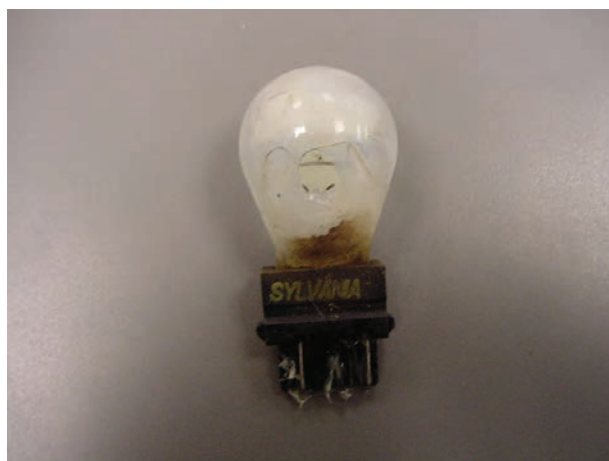
شکل ۱۴۱- اثر عوامل فیزیکی در معیوب شدن لامپ
