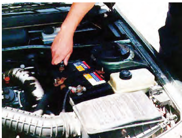
شکل ۱۶۴-۲ بازکردن کابل اتصال بدنه‌ی باتری
