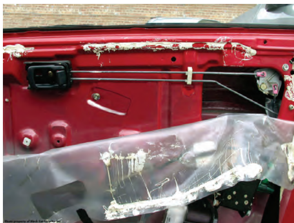
شکل ۲-۲۶- جدا کردن پلاستیک محافظ روی در
