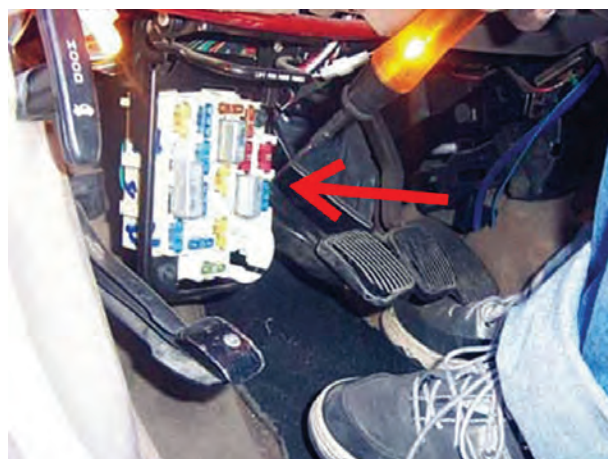
شکل ۱۸۹-۲ – آزمایش پایه‌های فیوز
