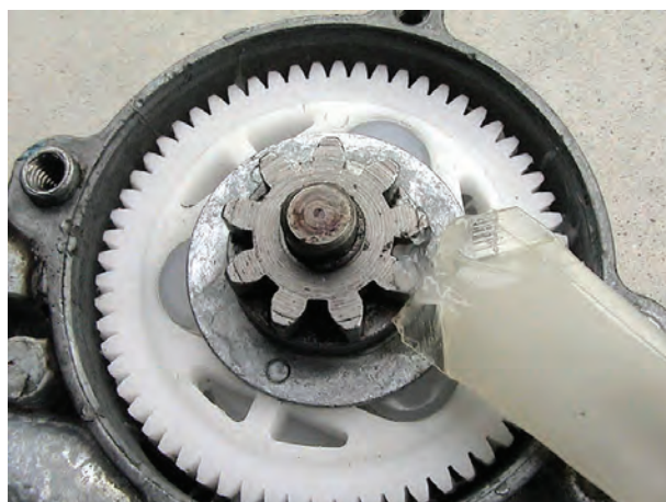
شکل ۱۳۰-۲- روغن کاری چرخ دنده ها
