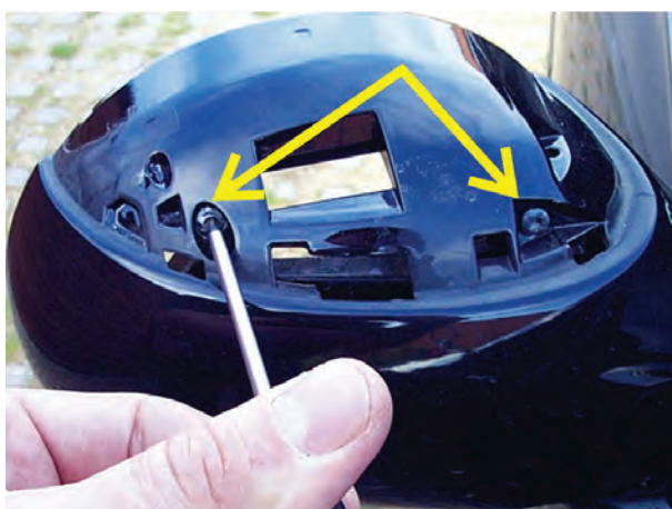
شکل ۱۷۴-۲- باز کردن پیچ‌های قاب بیرونی آینه
