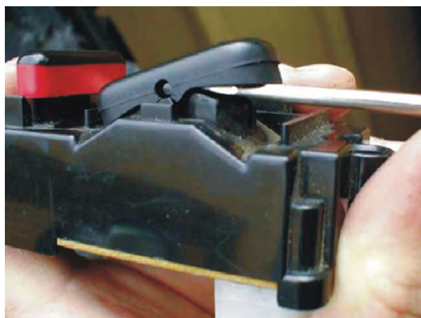
شکل ۲-۱۴۵ - تعویض شستی معیوب
