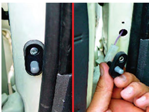
شکل ۱۹۲-۱- باز کردن سوئیچ لای در
