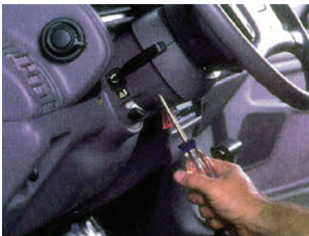
شکل ۱-۹۰- باز کردن پیچ‌های قاب سوئیچ روشنایی
