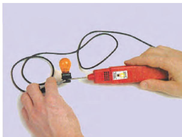
شکل ۱۸۲-۱- آزمایش لامپ چراغ راهنما
