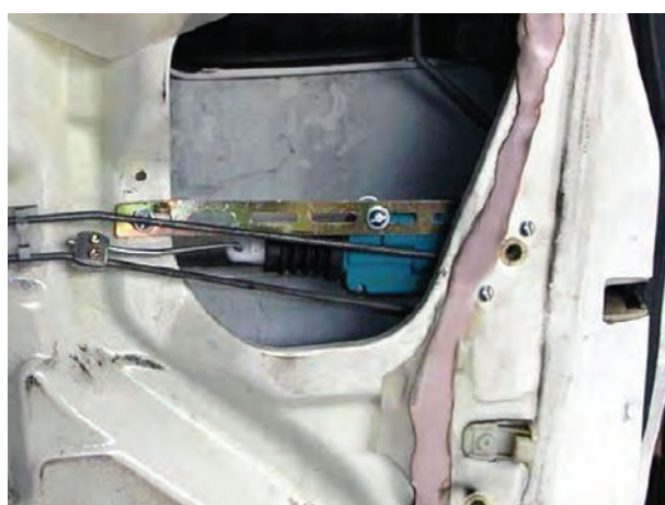
شکل ۳۷-۲ نحوه‌ی اتصال عملگر الکتریکی
