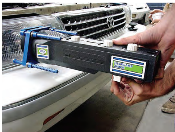
شکل ۱۶۴-۱- نصب هدف گیر به روی بلوری چراغ بزرگ جلو
