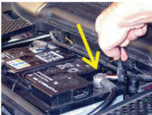
شکل ۱۴۱-۲ باز کردن کابل اتصال بدنه‌ی باتری
