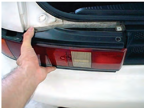
شکل ۱-۵۸- جدا کردن چراغ عقب از بدنه‌ی خودرو
