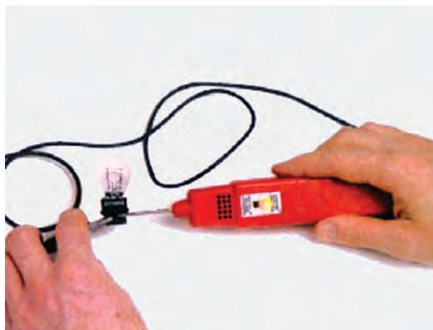
شکل ۲۱۹-۱- آزمایش لامپ چراغ صندوق عقب خودرو
