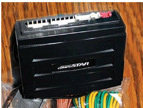
شکل ۵۷-۲ واحد اصلی سیستم دزدگیر
