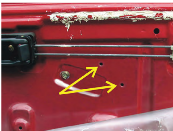
شکل ۲-۲۷ سوراخ کاری بدنه‌ی داخلی در خودرو
