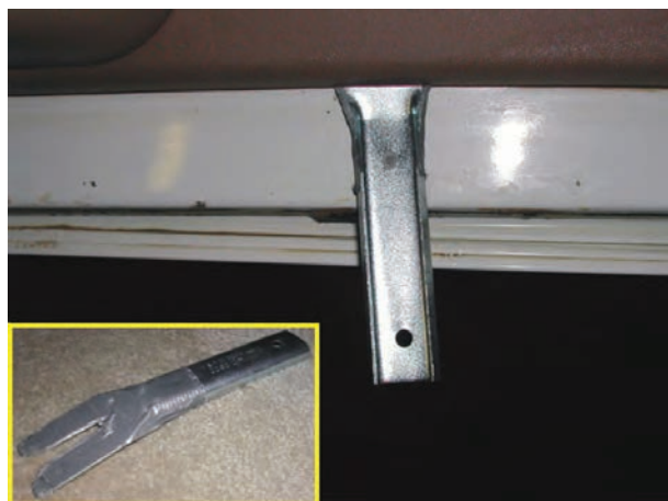
شکل ۲-۳۵- اهرم خاردرآر و نحوه‌ی استفاده از آن
