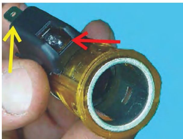
شکل ۱-۲۲۴- لامپ فندک و ترمینال الکتریکی آن
