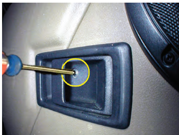
شکل ۳۶-۲ باز کردن قاب دستگیره‌ی قفل در
