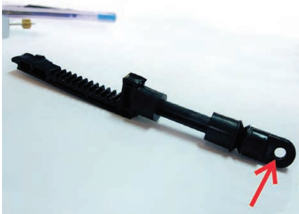
شکل ۲-۱۸- شانه‌ی دندانه‌دار دو قسمتی (محور عملگر)
