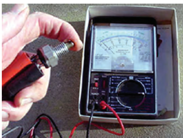
شکل ۱۰۵-۱- آزمایش سوئیچ چراغ‌های دنده عقب
