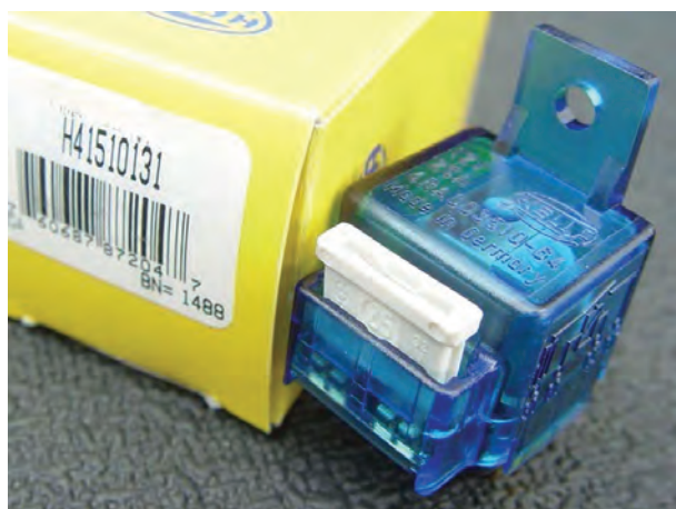
شکل ۱-۱۲۴ رله فیوزدار
