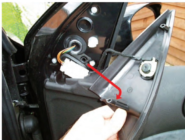
شکل ۱۶۵-۲ خارهای روی قاب و محل نصب آن
