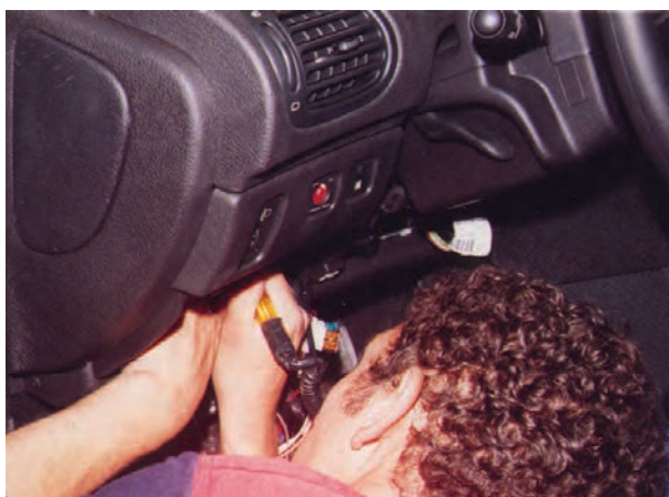
شکل ۲-۹۵- آزمایش برقراری جریان الکتریکی مدار
