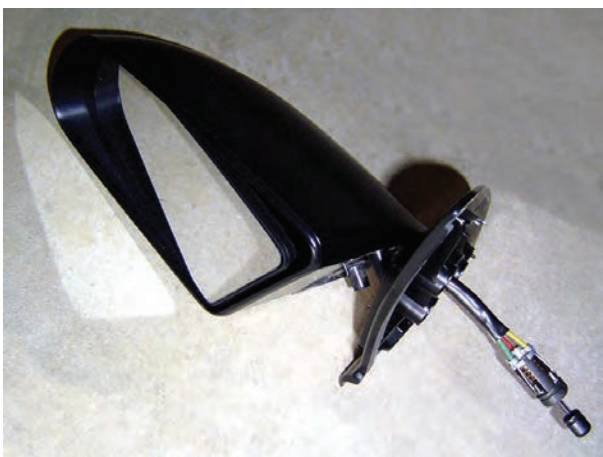
شکل ۱۵۶-۲- آینه‌ی جانبی و مکانیزم حرکت آن
