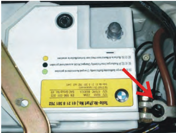
شکل ۹-۱-۲- باز کردن اتصال منفی باتری
