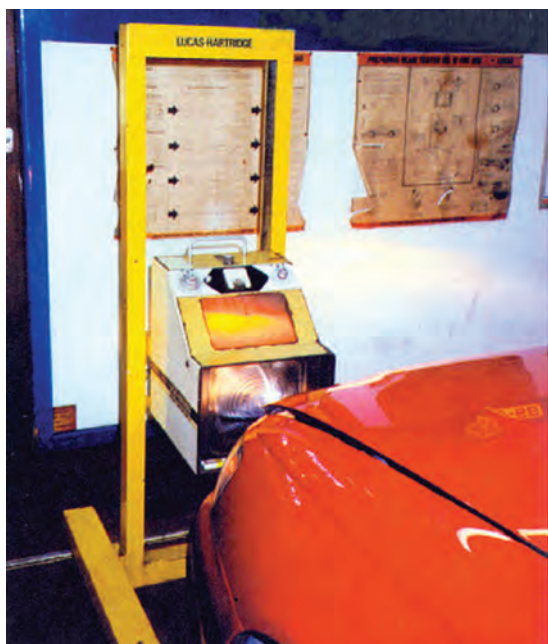
شکل ۱۵۳-۱- یک نوع دستگاه تنظیم نور چراغ‌های بزرگ
