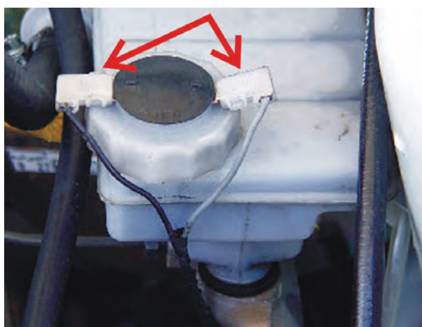
شکل ۲۰۳-۱- سوکت های اتصال پلاتین ها
