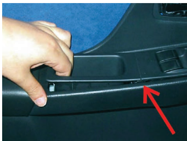
شکل ۱۸۳-۲ خارج نمودن قاب سوئیچ‌ها
