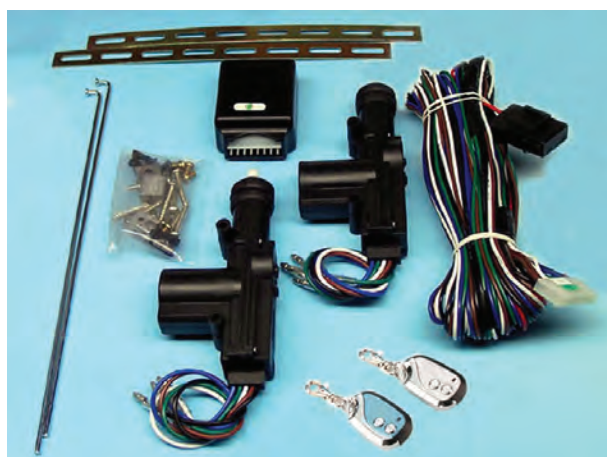
شکل ۱-۲- اجزای مدار قفل مرکزی
