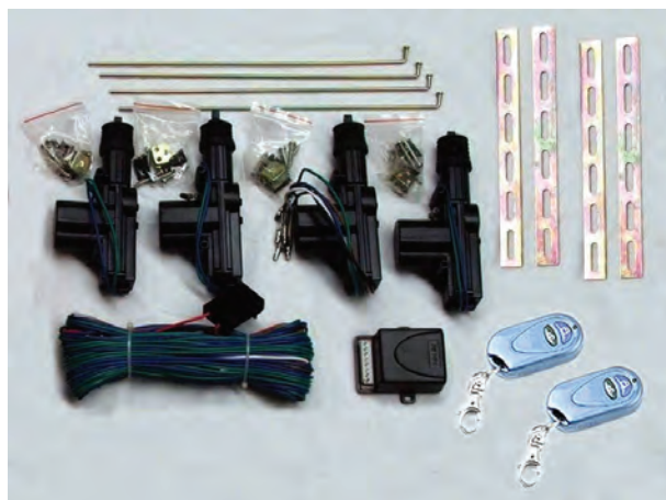
شکل ۲-۴- قطعات مدار الکتریکی قفل مرکزی
