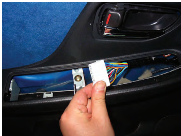
شکل ۱۸۵-۲- سوکت اتصال دسته سیم به سوئیچ‌ها
