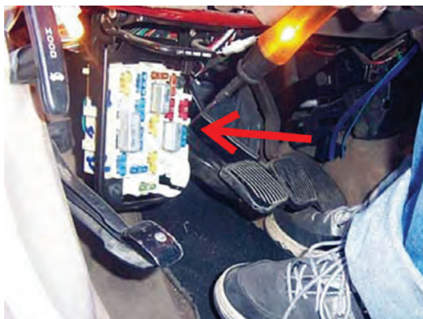
شکل ۱۲۰-۱ آزمایش جعبه‌ی فیوز با چراغ آزمایش
