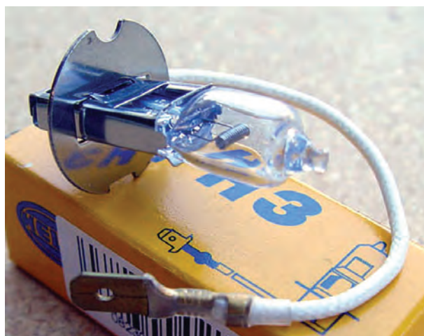
شکل ۱-۳۱- لامپ مورد استفاده در چراغ‌های مه‌شکن، نورافکن‌ها
