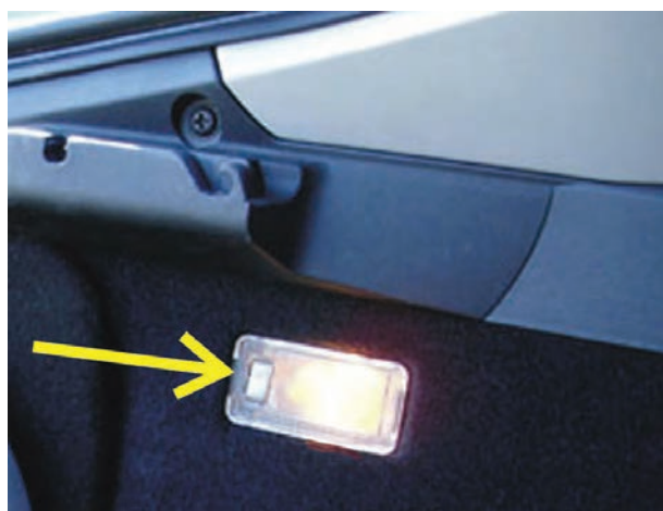
شکل ۲۱۸-۱- چراغ صندوق عقب و سوئیچ روی آن
