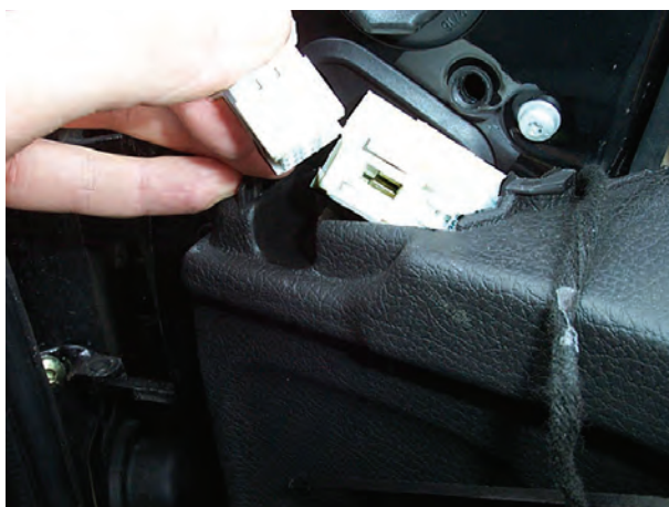
شکل ۱۶۶-۲- جدا کردن سوکت سیم کشی آینه
