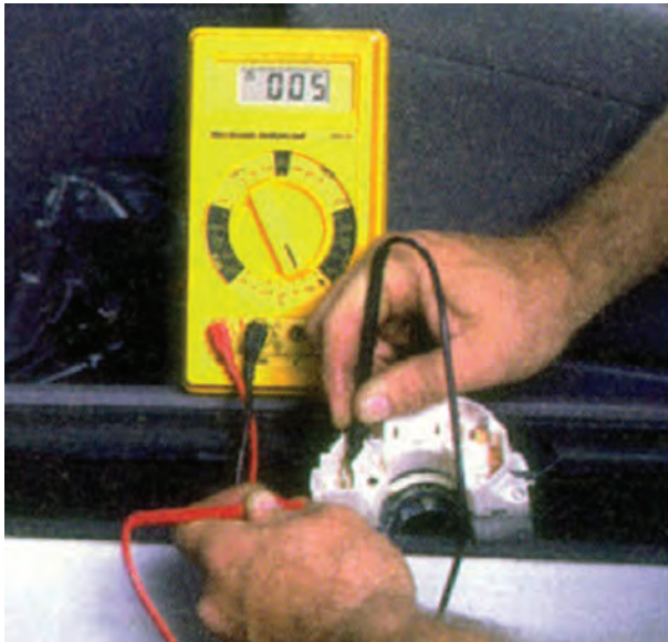
شکل ۹۷-۱- آزمایش سوئیچ روشنایی
