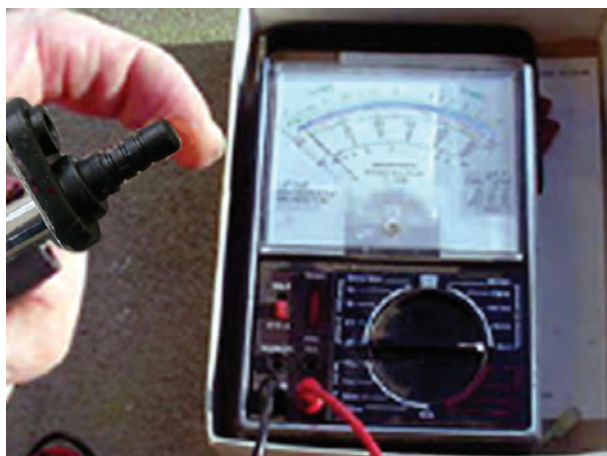
شکل ۱۹۶-۱- آزمایش سوئیچ لای در
