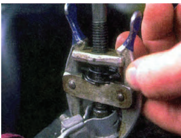
شکل ۱-۸۹- باز کردن بست اتصال بدنه‌ی باتری
