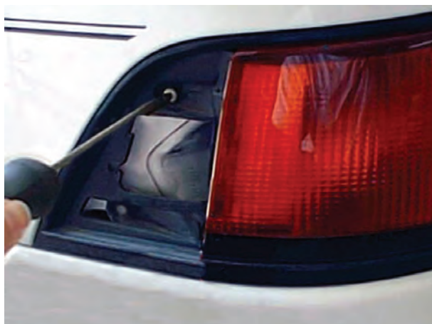
شکل ۱-۵۶- باز کردن پیچ‌های قاب چراغ
