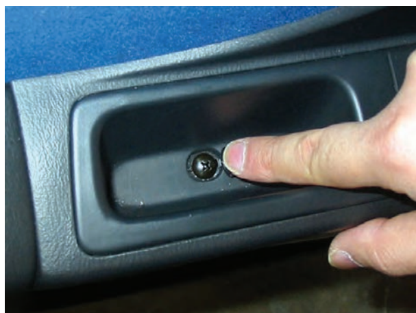
شکل ۱۸۲-۲ پیچ اتصال قاب سوئیچ به بدنه
