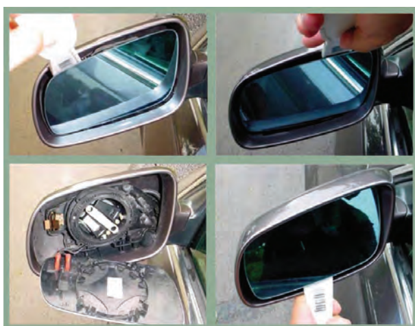
شکل ۱۶۷-۲- بیرون آوردن آینه از داخل قاب آن
