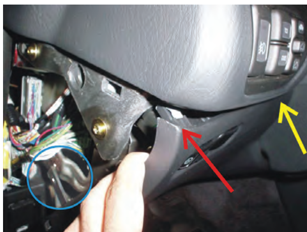
شکل ۸۵-۱- خارج کردن قاب از روی بدنه‌ی پانل
