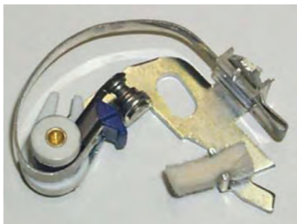
شکل ۲۲-۱۰- نمد روغن کاری بادامک
