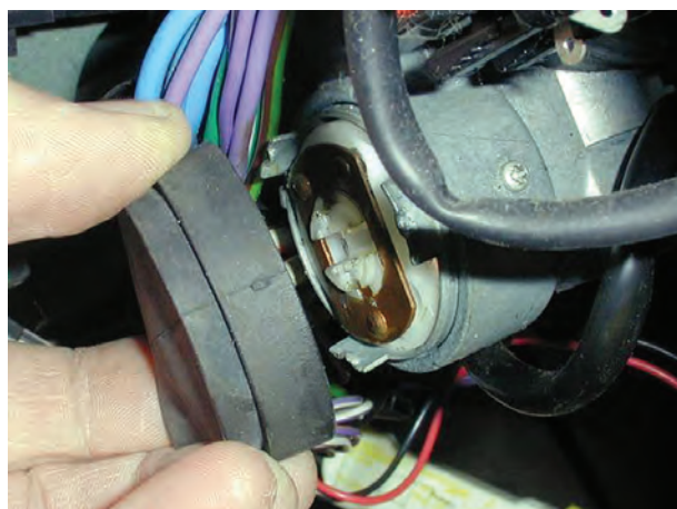
شکل ۱۱-۱۳- بیرون آوردن فیبری پشت سوئیچ
