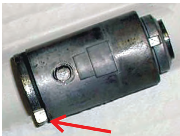
شکل ۱۹-۱۱- مغزی سوئیچ اصلی موتور
