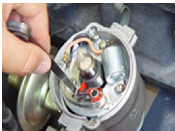
شکل ۴۸-۱۰ قرار دادن فیلر در دهانه‌ی پلاتین
