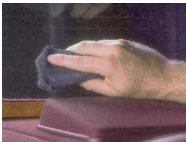
شکل ۳-۲۲- تمیز کردن محل قطع شده‌ی المنت حرارتی
