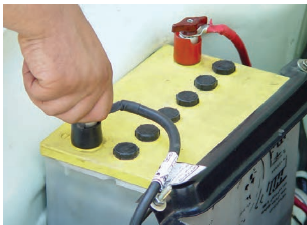
شکل ۱-۴۹- باز کردن اتصال بدنه باتری
