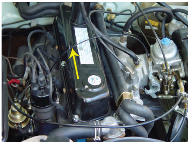
شکل ۲۸- ۱۰- لوله‌ی رابط آوانس خلثی به کاربراتور
