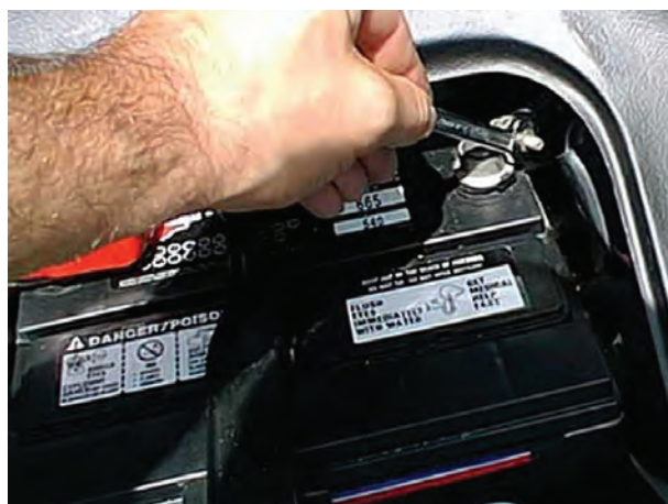
شکل ۱۲-۳- بستن کابل اتصال بدنه‌ی باتری
