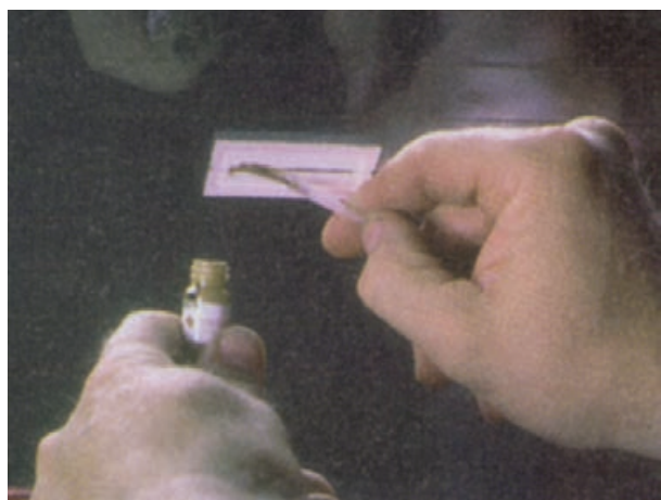
شکل ۳-۲۵- مالیدن مواد بین دو نوار روی شیشه
