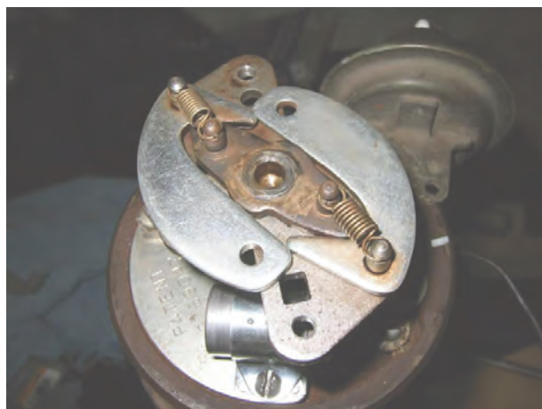
شکل ۲۴-۱۰- دستگاه آوانس وزنه‌ای دلکو
