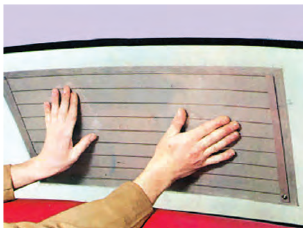
شکل ۹-۳- نحوه چسباندن المنت حرارتی
