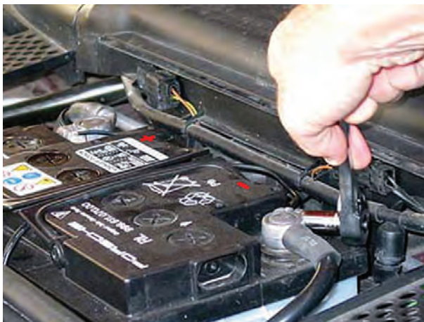
شکل ۱۸-۵- باز کردن کابل اتصال بدنه‌ی باتری
