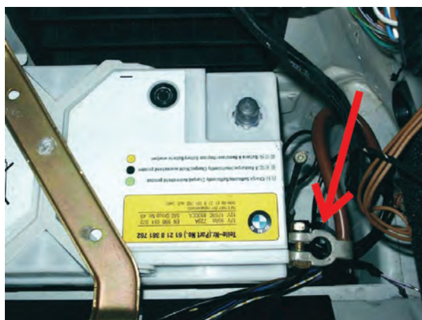
شکل ۹-۱۱- باز کردن کابل اتصال بدنه‌ی باتری
