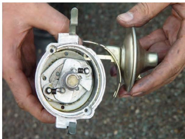
شکل ۳۱-۱۰ جدا کردن مجموعه‌ی آوانس خلئی
