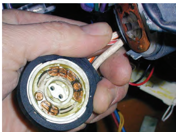
شکل ۱۱-۱۴- ترمینال داخل فیبری سوئیچ
