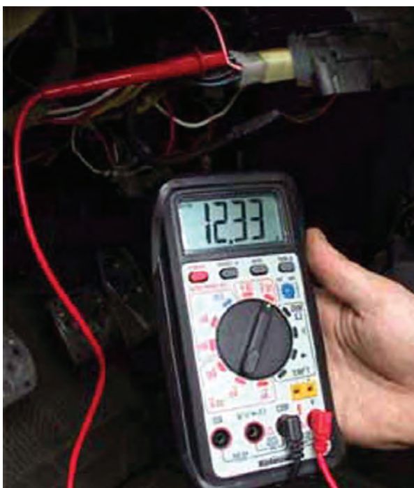
شکل ۲۸-۱۱ اندازه‌گیری ولتاژ در ترمینال ورودی سوئیچ
