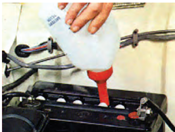
شکل ۱-۷۴- کنترل سطح الکترولیت
