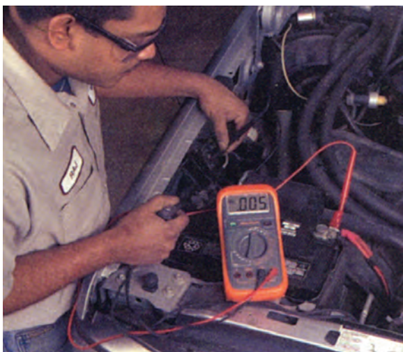
شکل ۸-۴۱- اندازه‌گیری افت ولتاژ کابل متصل به رله
