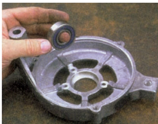
شکل ۷۰-۷ - خارج کردن بلبرینگ و آزمایش آن
