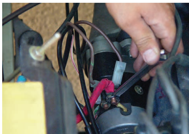
شکل ۸-۴۸ – جدا کردن اتصالات الکتریکی استارتر
