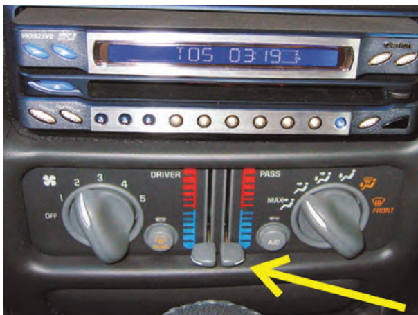
شکل ۴-۵۴- اهرم‌های تنظیم هوای ورودی
