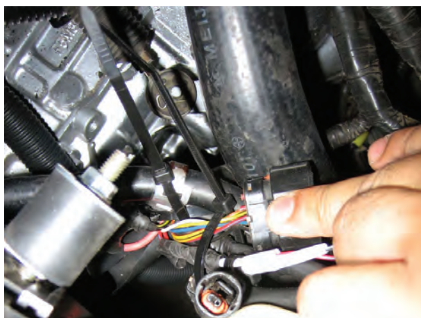
شکل ۴۵-۵ بررسی اتصالات الکتریکی سیم‌کشی
