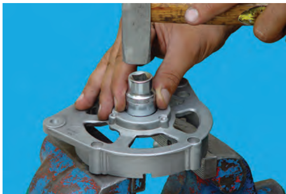
شکل ۶۹-۷ - بیرون آوردن بلبرینگ
