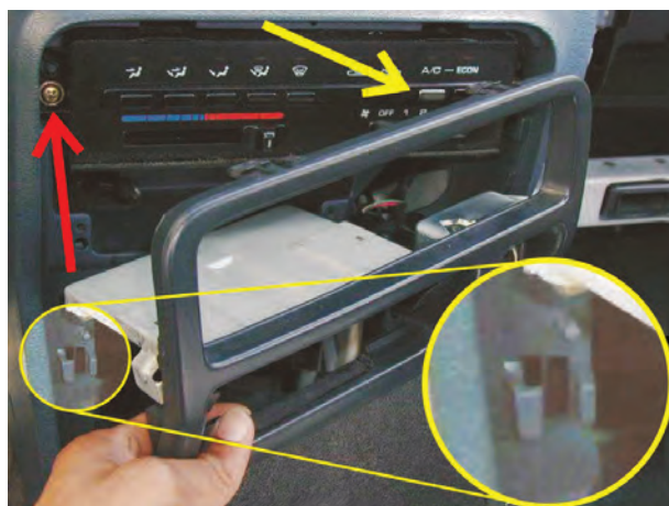
شکل ۳۸-۵ باز کردن قاب سوئیچ‌ها
