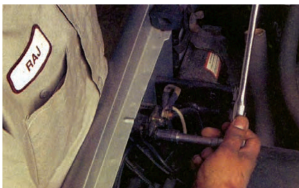
شکل ۸-۴۵ - اندازه‌گیری افت ولتاژ رله‌ی استارت
