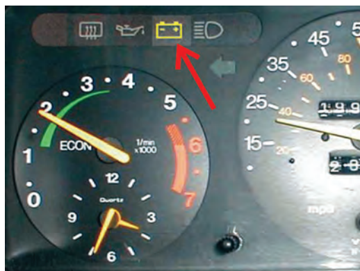
شکل ۱۰-۳ لامپ شارژ یک نوع خودرو
