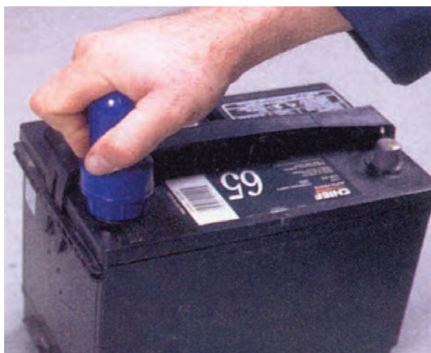
شکل ۸۹-۱ - نحوه‌ی استفاده از ابزار مخصوص باتری
