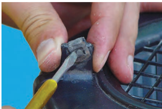
شکل ۴-۳۸ – باز کردن ضامن خار
