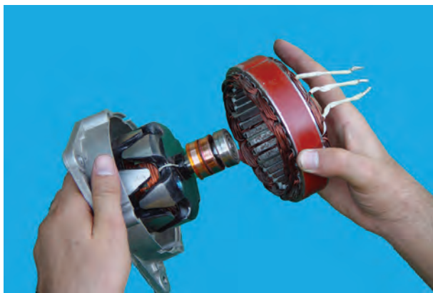
شکل ۶۲-۷ – جدا کردن استاتور
