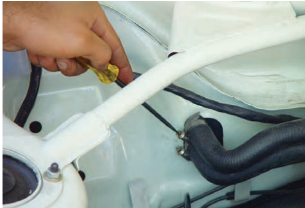
شکل ۴-۳۱- باز کردن لوله‌های آب رادیاتور بخاری
