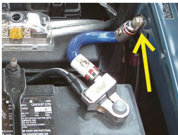
شکل ۲-۲۴ اتصال کابل منفی باتری به بدنه
