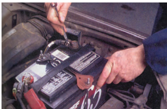
شکل ۹۵-۱ اتصال کابل‌های مثبت و منفی باتری
