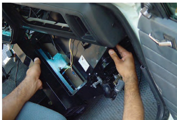
شکل ۴-۳۴- خارج کردن بخاری از محل نصب آب
