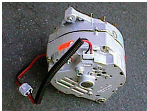
شکل ۳-۱۶- آلترناتور مجهز به آفتامات الکترونیکی
