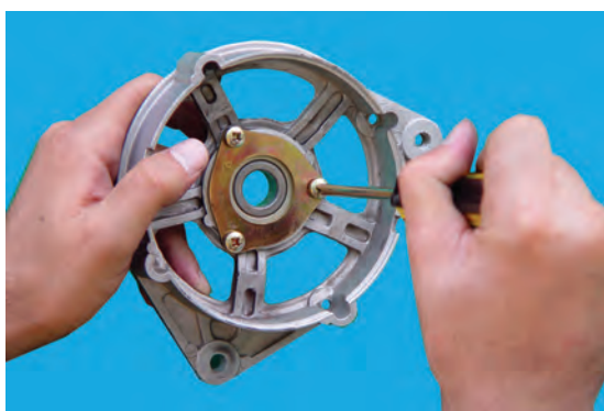
شکل ۶۷-۷ - باز کردن پیچ‌های نگهدارنده‌ی بلبرینگ
