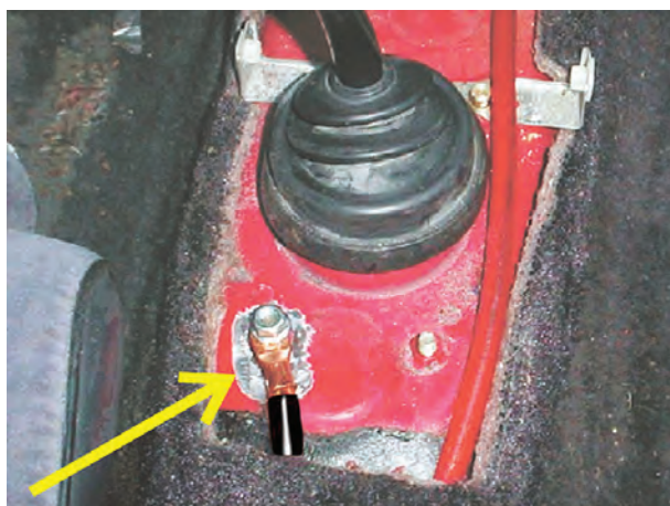
شکل ۲-۲۵- اتصال بدنه‌ی باتری در داخل اتاق خودرو
