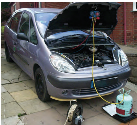
شکل ۳۵-۵ شارژ گاز کولر
