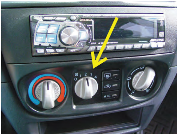
شکل ۴-۵۲- سوئیچ فن چهار وضعیتی
