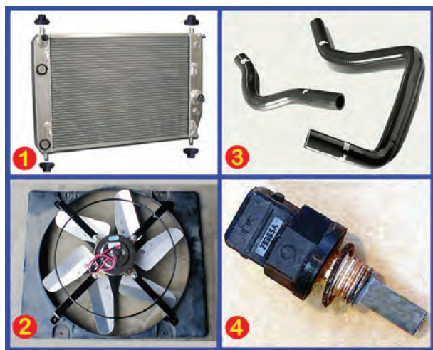
شکل ۲-۶- اجزای مدار خنک کاری
