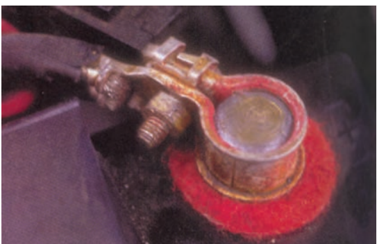
شکل ۹۷-۱ گریس زدن بست قطب‌ها
