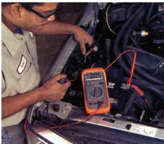
شکل ۸-۴۰- اتصال سیم منفی ولت‌متر به ورودی رله
