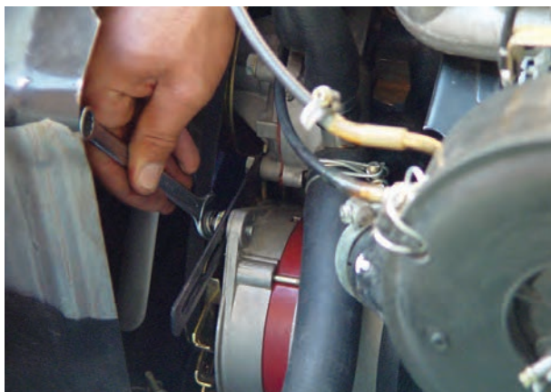
شکل ۷-۴۹ - باز کردن پیچ کشش تسمه پروانه
