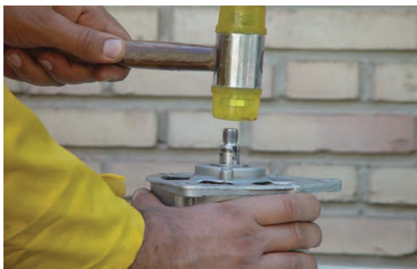
شکل ۶۳-۷ – بیرون آوردن روتور از درپوش
