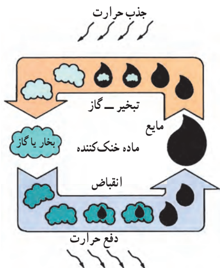
شکل ۵-۳- مراحل تغییر ماده خنک‌کننده
