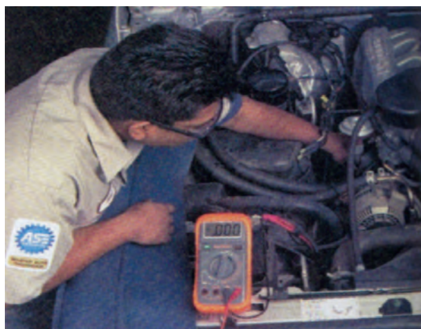
شکل ۸-۳۴- اتصال سرسیم منفی مولتی متر به اتصال کابل باتری استارتز
