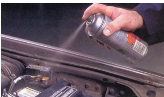
شکل ۹۶-۱ پاشیدن محلول ضد خوردگی روی بست
