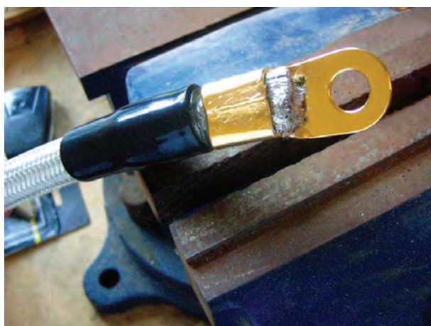
شکل ۲-۳۱ - استفاده از گیره فلزکاری برای پرچ بست در روی کابل
