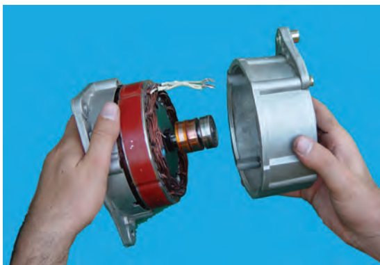
شکل ۶۱-۷ – جدا کردن درپوش‌های آلترناتور
