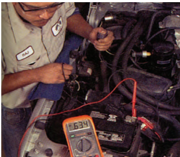
شکل ۸-۳۹- آزمایش افت ولتاژ باتری به خروجی رله
