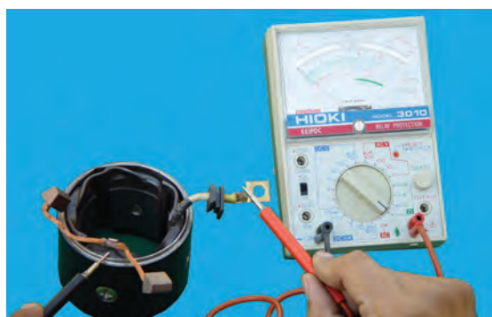
شکل ۸-۷۵ - آزمایش اتصال بدنه‌ی بالشتک
