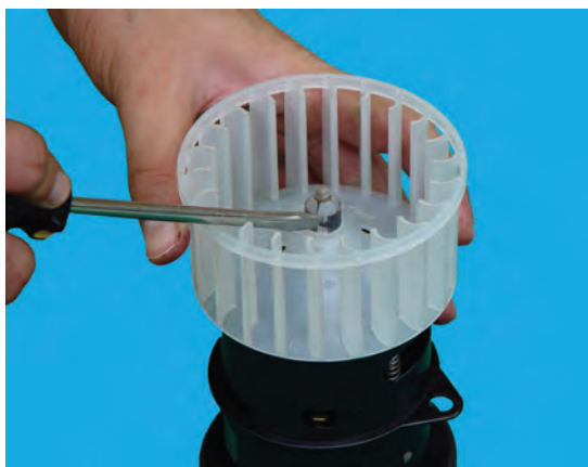
شکل ۴-۴۲- درآوردن خار نگهدارنده‌ی فن
