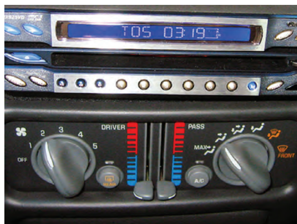
شکل ۵-۲۳ سوئیچ راه‌انداز فن کولر
