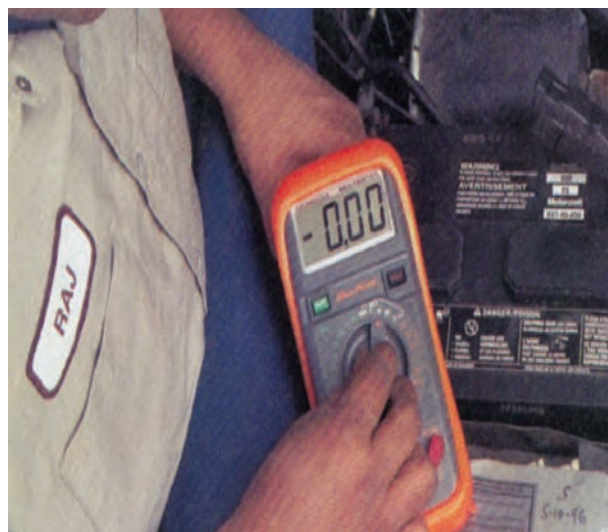
شکل ۸-۳۵- تنظیم مولتی متر روی شاخص ولتاژ
