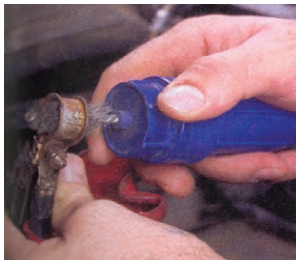
شکل ۹۱-۱ - پاک کردن بست‌های باتری با برس سیمی
