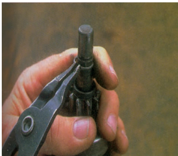
شکل ۸-۶۱ – درآوردن خار رینگ‌ی
