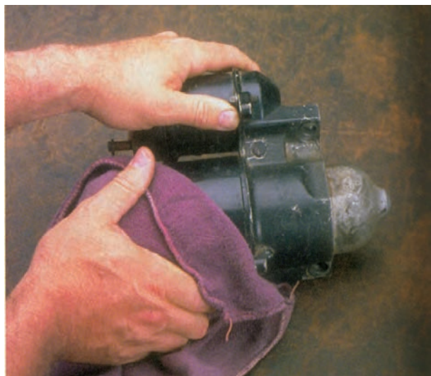
شکل ۸-۵۰ - تمیز کردن استارتر
