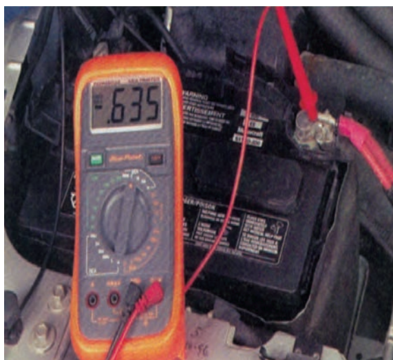
شکل ۸-۳۷ اندازه‌گیری افت ولتاژ جریان ورودی کابل استارتر
