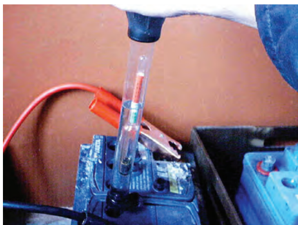
شکل ۱-۵۳- کنترل غلظت الکترولیت
