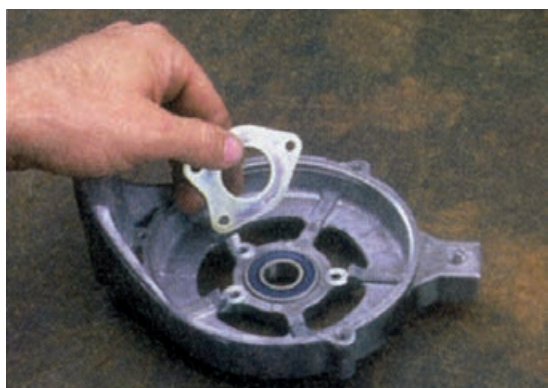
شکل ۶۸-۷ - در آوردن نگهدارنده‌ی بلبرینگ
