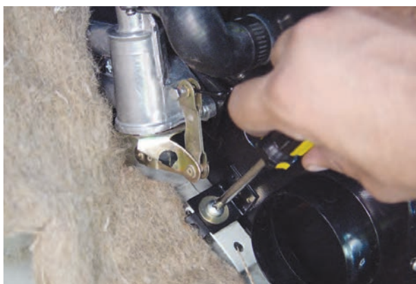
شکل ۴-۳۳- پیچ‌های پایه‌ی بخاری
