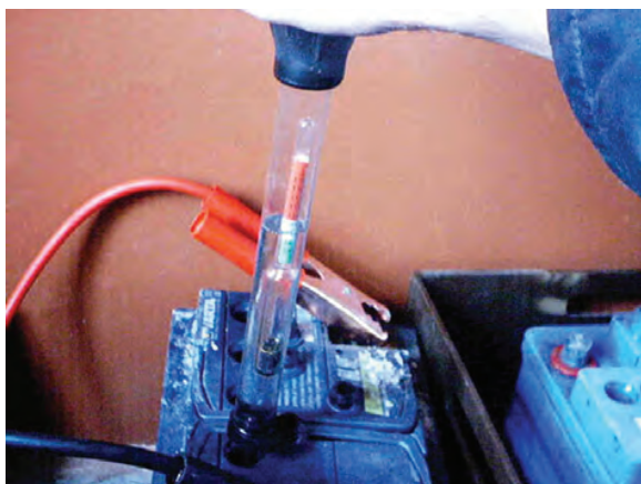
شکل ۱-۶۲ - کنترل غلظت الکترولیت
