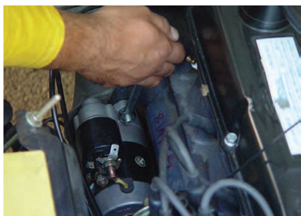
الف – باز کردن پیچ‌های استارتر
