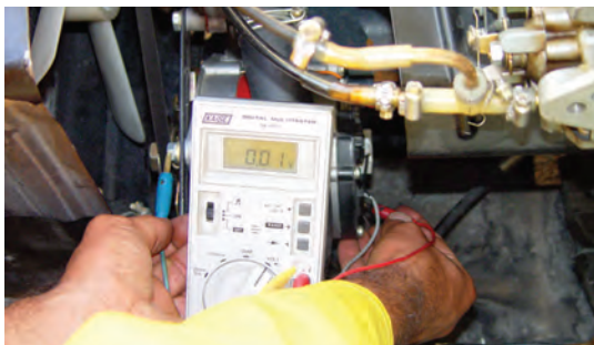
شکل ۷۲-۷۱ - اتصال ولت‌متر بین ترمینال B و بدنه
