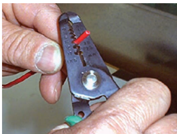
شکل ۳-۳۸- جدا کردن عایق سر سیم‌ها
