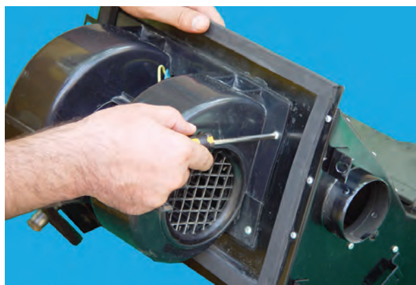
شکل ۴-۳۶- باز کردن پیچ‌های محفظه‌ی موتور
