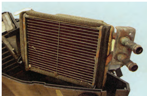
شکل ۳۰-۴- رادیاتور بخاری
