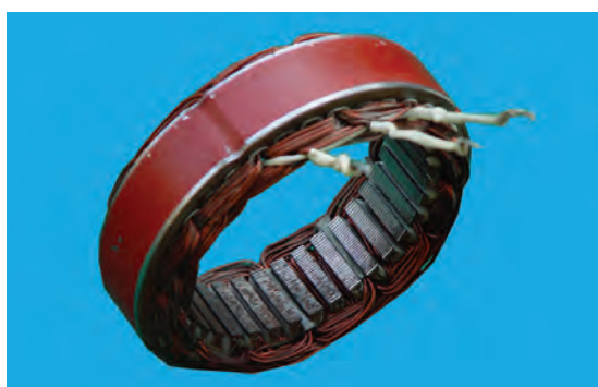
شکل ۷-۳۷ - استاتور با سرپیچ های خروجی
