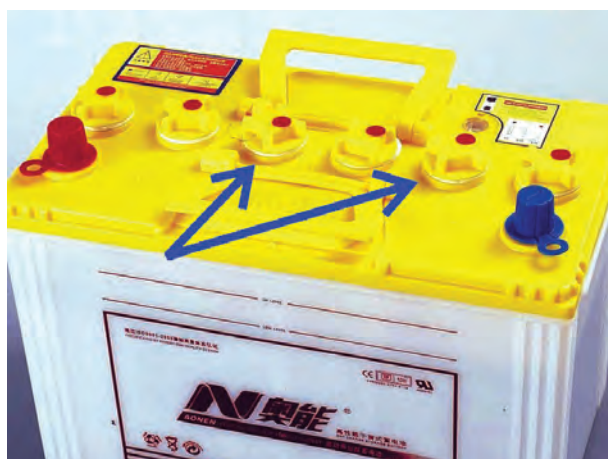
شکل ۴-۱- درپوش خانه‌های باتری
