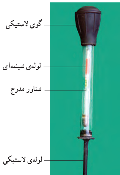
شکل ۱-۱۴- دو نوع هیدرومتر یا چگالی سنج
