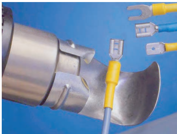
شکل ۷۹-۸- عایق کاری اتصال سرسیم به سیم
