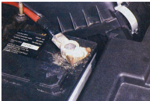
شکل ۸-۳۱ سولفات شده شدن اتصال قطب باتری
