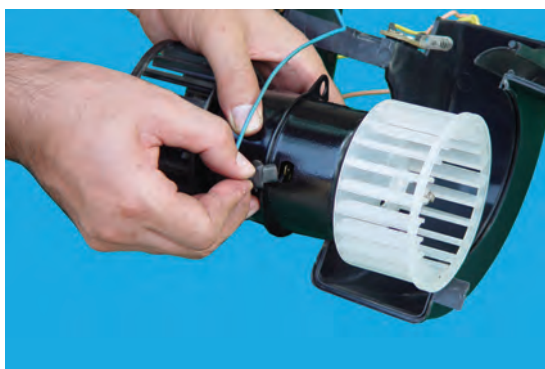
شکل ۴-۴۱- جدا کردن سیم از زغال‌ها
