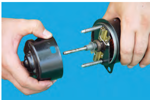
شکل ۴۵-۴ جدا کردن پوسته‌ی موتور
