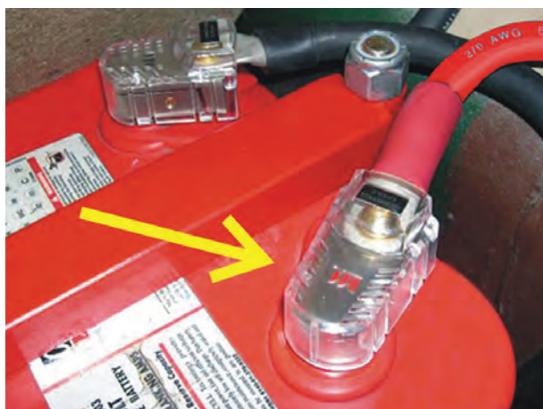
شکل ۱۹-۲- مورد استفاده تلق محافظ قطب‌های باتری
