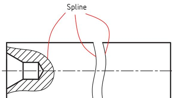
این فرمان برای ایجاد منحنی نقطه‌یابی، مطابق شکل روبه‌رو، کاربرد دارد. منحنی Spline، منحنی است که از شعاع خاصی تبعیت نمی‌کند بلکه با تعیین نقاطی در مسیر منحنی یا به عبارتی نقطه‌یابی ترسیم می‌شود. این نوع منحنی علاوه بر موارد مشخص شده شکل روبه‌رو، در ترسیم فصل مشترک احجام و شبیه آن نیز کاربرد دارد.
