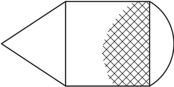
همان‌طور که می‌دانید در نقشه‌کشی صنعتی هاشور آج اغلب به صورت موضعی، مطابق شکل روبه‌رو، رسم می‌شود. به همین منظور در اتوکد چندین روش به شرح زیر وجود دارد.
