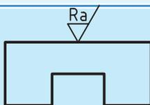
۶. در پاسخ به پیغام مقابل Specify insertion point for block محل درج (استقرار) بلوک را تعیین می‌کنیم. نتیجه آن نیز مطابق شکل روبه‌رو است.
