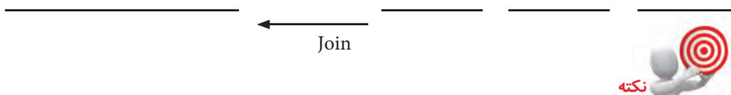
اگر دو خط بر روی هم رسم شده باشند با فرمان Join به یک خط تبدیل می شوند.
