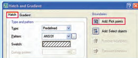
۴. در پنجره Hatch and Gradient بر روی دکمه **Add pick points** کلیک می‌کنیم.
