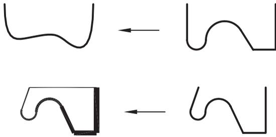
این فرمان برای ویرایش چند خطی‌ها کاربرد دارد. عملیاتی مانند تبدیل چند خطی به منحنی (Spline)، تغییر پهنای خطوط (Width)، یکی کردن اشیاء (Join)، بستن اشیاء (Close) از جمله کارهایی است که با فرمان Pedit انجام می‌شود. همچنین اشیاء انتخابی می‌توانند چند خطی‌های دوبعدی یا سه بعدی باشند.
