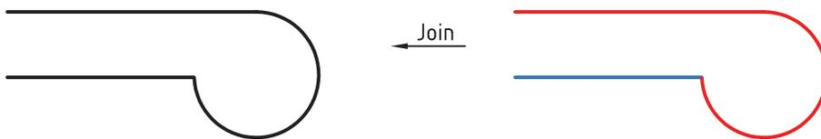
◀ Splines (منحنی‌ها): با اجرای فرمان Join در صورتی که شیء مرجع Spline باشد، اشیاء متصل‌شونده می‌توانند Spline یا Helix باشند. Helix‌ها منحنی‌های مارپیچ‌اند، در این حالت نیز منحنی‌های انتخابی نباید فاصله داشته باشند.
