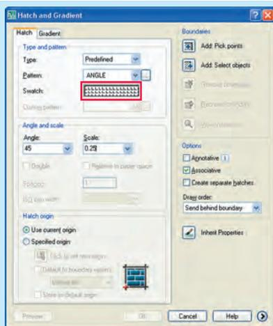
۲. در پنجره Hatch and Gradient سربرگ Hatch در قسمت Swatch روی الگوی هاشور کلیک می‌کنیم.
