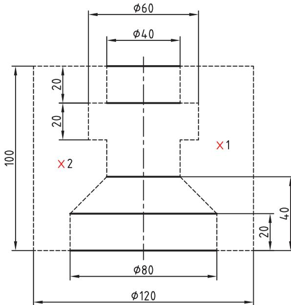
۶. به کمک گزینه Addpick points، مطابق شکل روبه‌رو، درون محدوده‌های موردنظر (نقاط 1 و 2) کلیک کنید تا مرزهای آن به صورت خط چین درآید.
