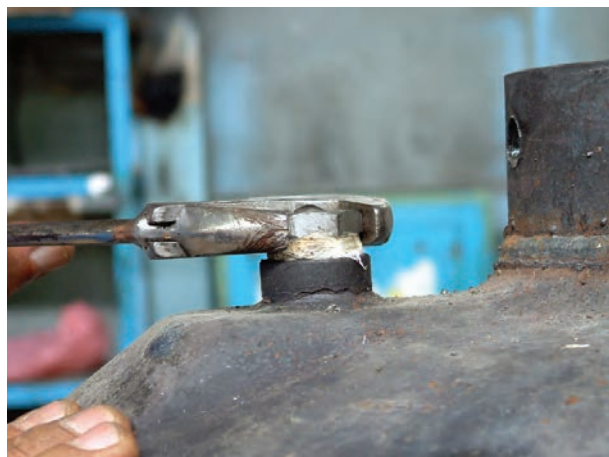
شکل ۱-۲۴- نحوه‌ی بازکردن میله‌ی منیزیم از محل خود
