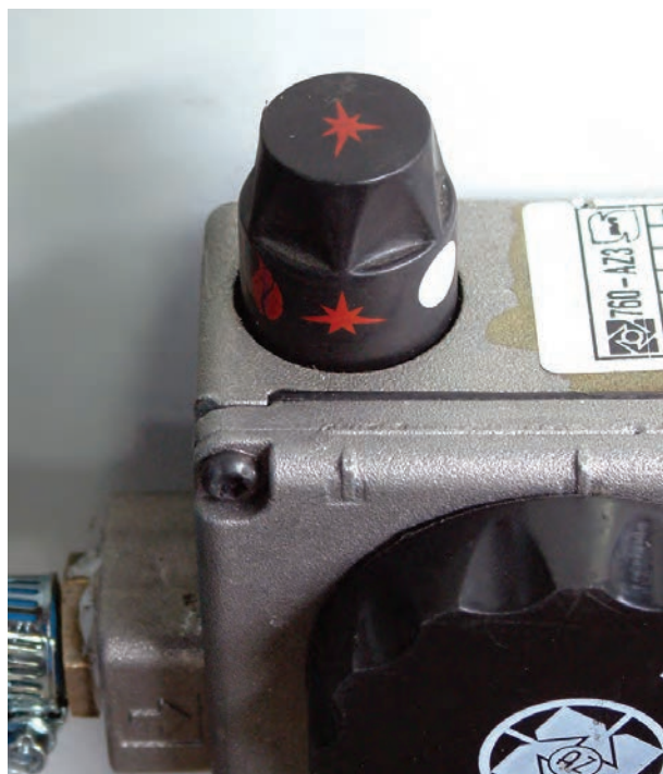
شکل ۱-۱۰۳- گرداندن دگمه ی فرمان و قراردادن آن در حالت شمعک
