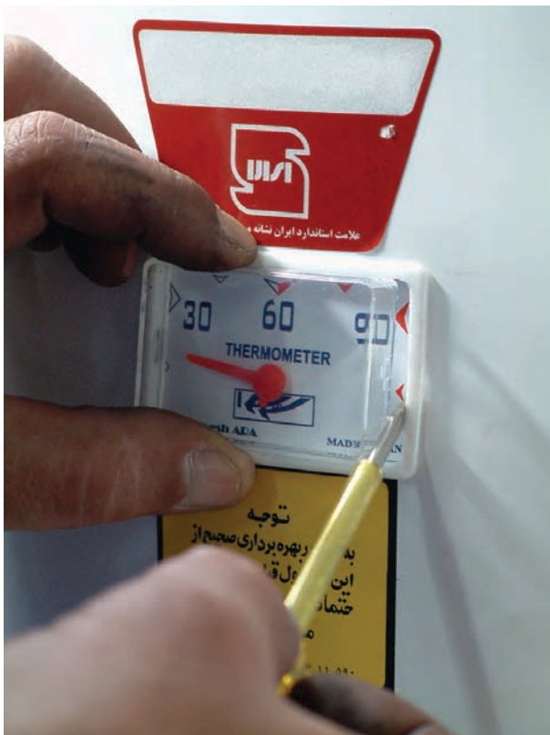
شکل ۱-۱۱۶- جدا کردن ترمومتر
